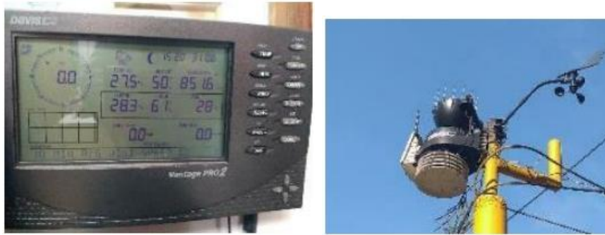
Figura N° 07 : Equipo medición de Temperatura Ambiental (anemómetro ambiental: Equipo DAVIS ), también registra velocidad de aire y humedad.
