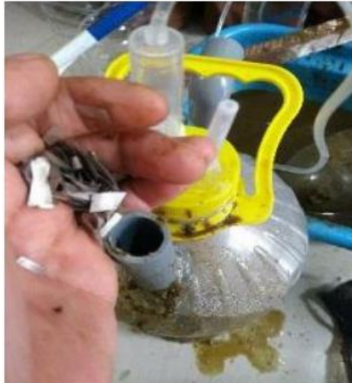
Figura N° 05: Ingreso de Residuos Alimenticios al Biodigestor 1 y 2.
