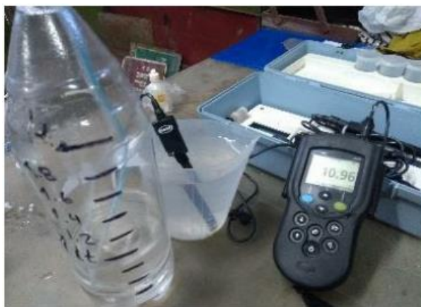
Figura N° 11: POH del agua del gaseómetro llega hasta 10:96 altamente alcalina para retener al CO2 que sale de los biodigestores 1
