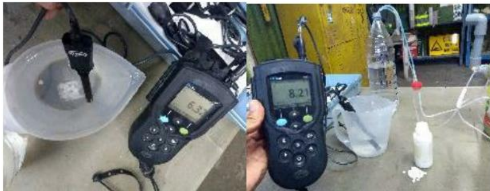
Figura N° 10: PH del agua del gaseómetro 6.32 va subiendo a 8:21 con una sola pastilla de NaOH al 99%.
