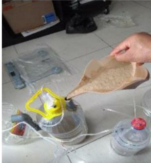
Figura N° 05: Ingreso de Residuos Alimenticios al Biodigestor 1 y 2.
