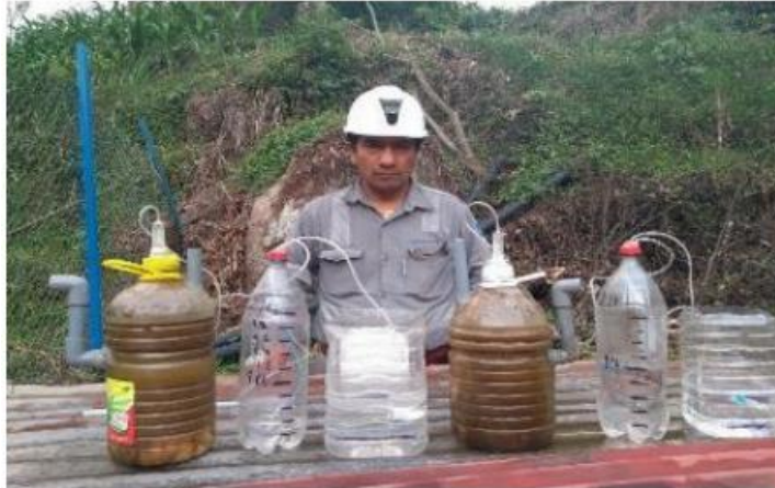
Figura N° 06: Biodigestor 1 y 2 con sus gaseómetros marcados a 200 ml. y recipiente para evacuación del agua.
