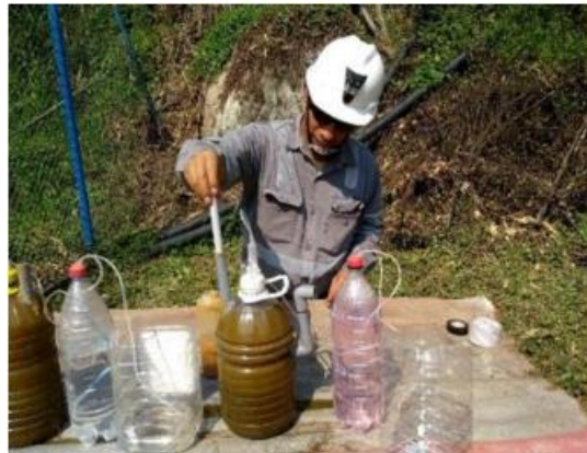
Figura N° 14: Se ingresa un pequeño tubo para disolver la solución desde la base del biodigestor 01 y 02.
