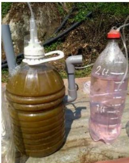
Figura N° 16: Biodigestor 02: 1er día evacúa 50 ml. 2do día 100ml Total: 150 ml.
