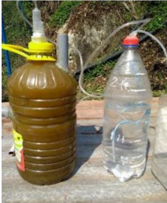
Figura N° 15: Biodigestor 01: 1er y 2do día evacúa 200 ml.
