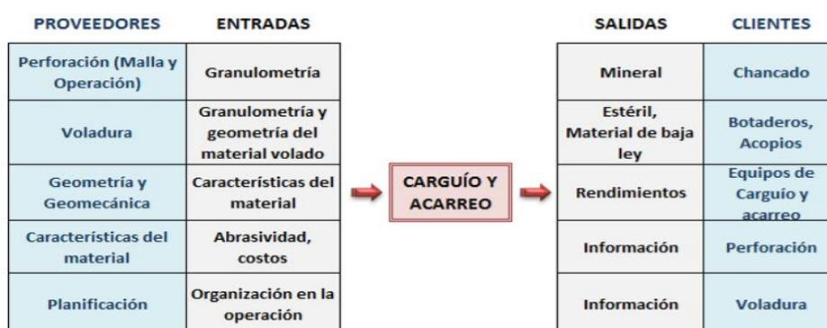
Figura 3: Esquema de procesos involucrados en el carguío y acarreo. (Barrientos, 2014)
