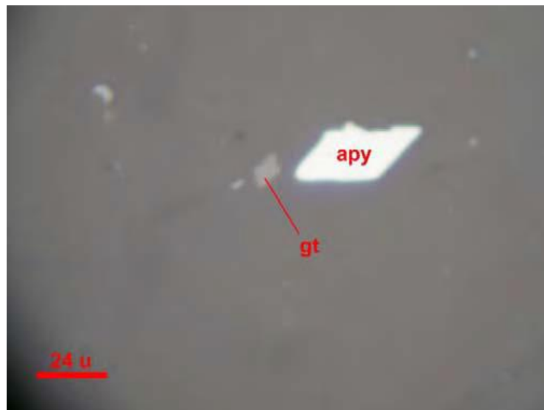
Foto 5 Se observa partículas libres de arsenopirita (apy) y de goethita(gt). Magnificación: 500X
