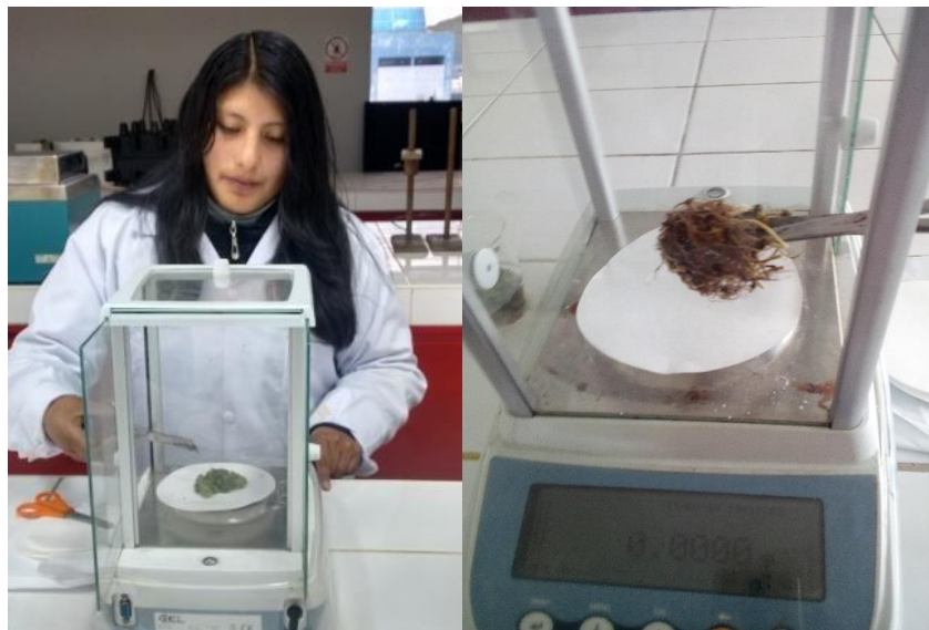
Fotografía N° 03 Pesado de las raíces secas de la Hydrocotyle vulgaris en la balanza analítica
