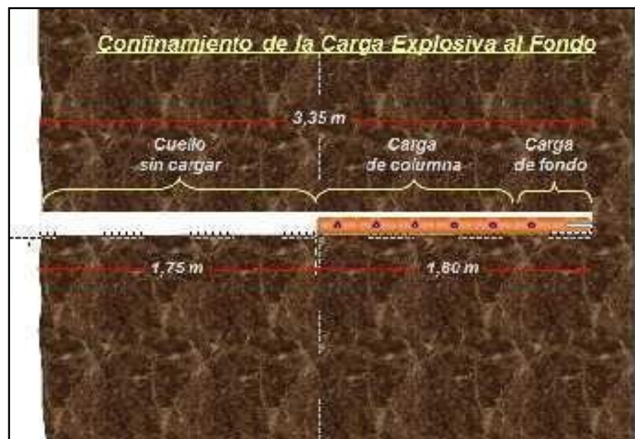
Figura N° 13 Carga explosiva al fondo
