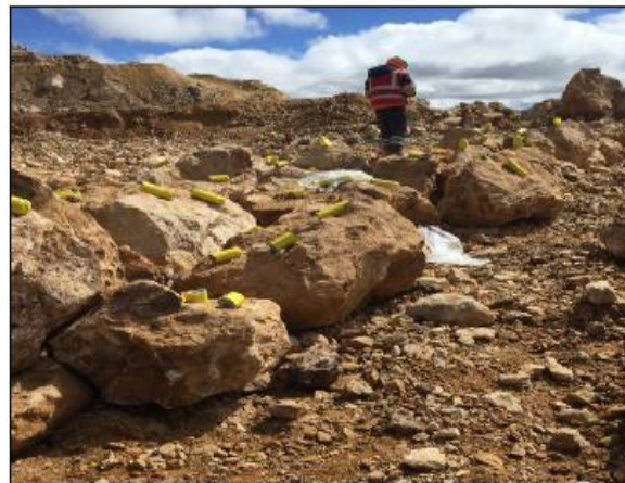
Figura N° 42. Frente de minado presencia de bancos grandes
