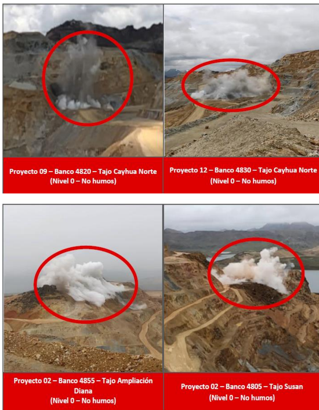
Figura N° 47. Humos generados en la voladura
