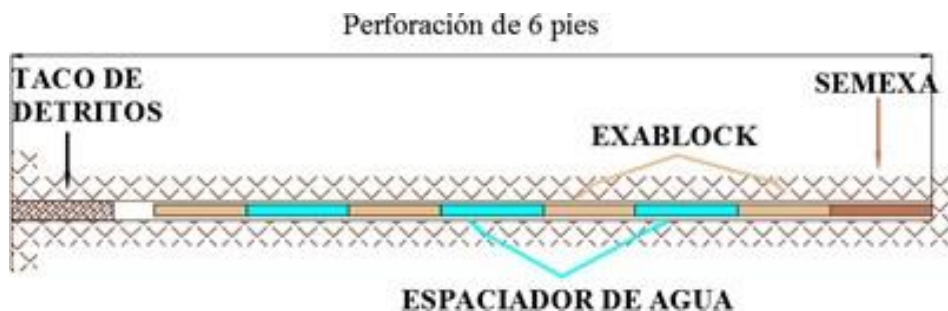
Figura N° 12: Espaciador de agua en la corona de la labor, 6', IVA
