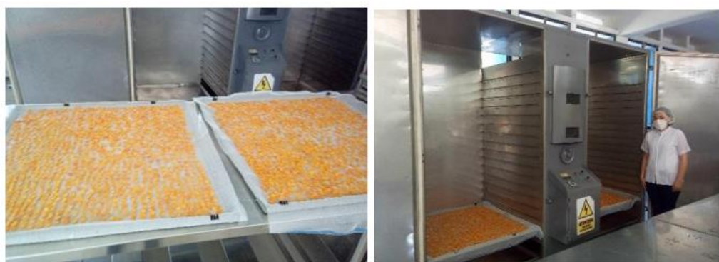
Figura 8. Secado del aguaymanto luego de la inmersión en jarabe.
