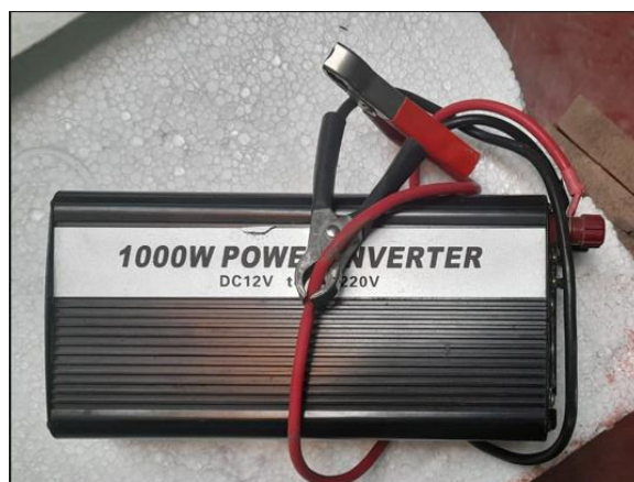
Ilustración 19: Inversor de voltaje DC/DA
