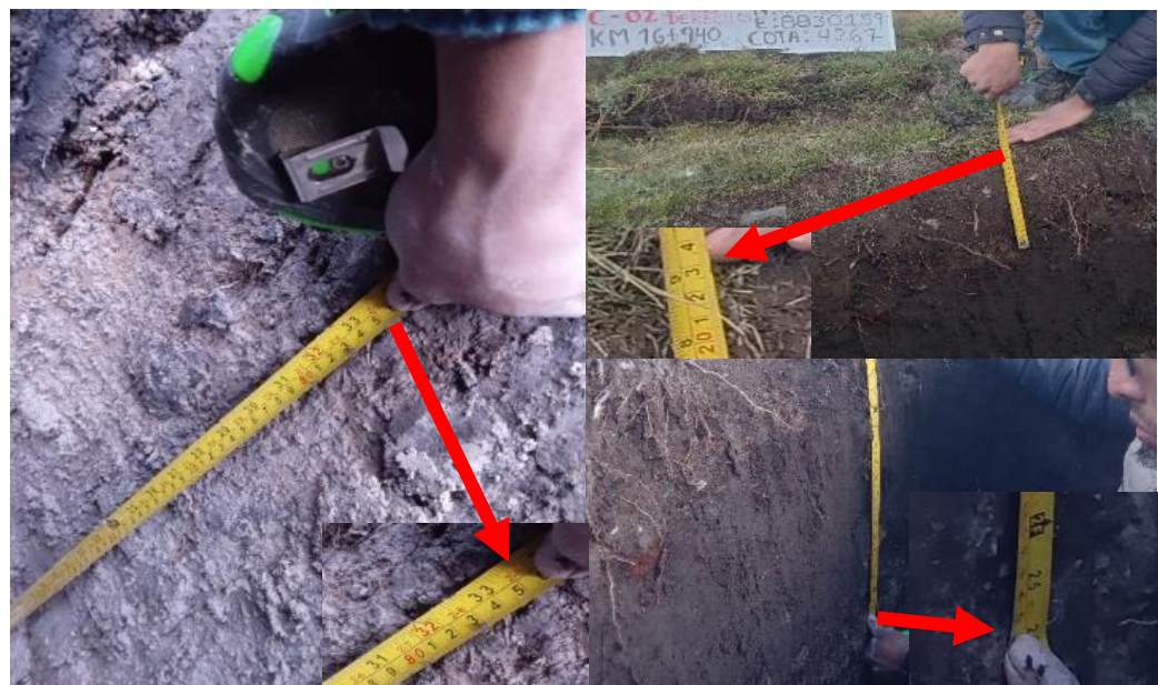
Medida del perfil estratigráfico de la Calicata 02, Progresiva 16+940 margen derecho, N 0351337, E 8830159, Cota 4267 m.
