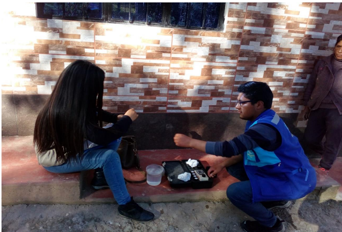
Foto 10: Tesista realizando el seguimiento y monitoreo de los diferentes parámetros físicos para verificar la calidad del agua en las viviendas del sistema de abastecimiento de agua “Chinuanhuay”, con el apoyo del personal del área de SAMA de la DIRESA PASCO.
