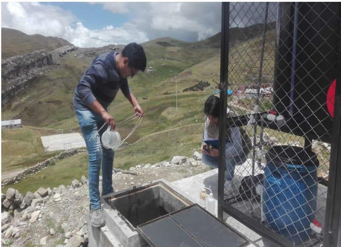
Foto 04: Tesista realizando la evaluación técnica, operativa, toma de datos y georreferenciación en el reservorio del sistema de abastecimiento de agua “Torhuaganga” – Ticlacayán.
