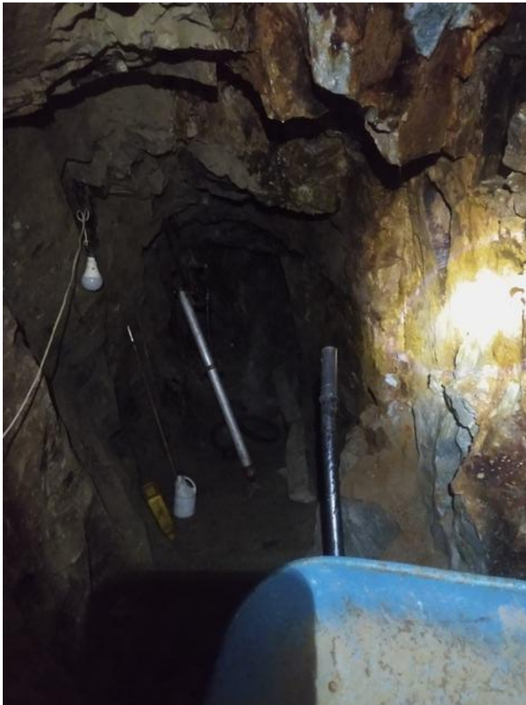
Galería de sección de 2,2 x 2,2 El Olivo
