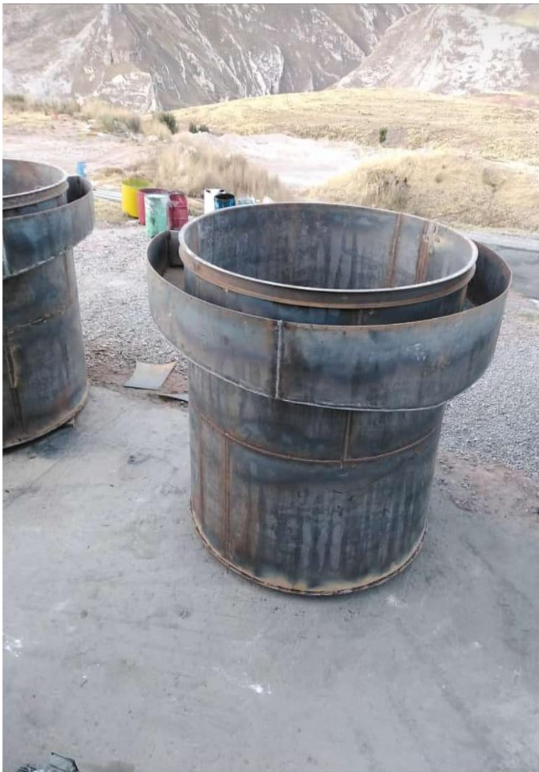
FOTO N° 5: Terminando la fabricación del primer prototipo de la celda 8' x 8'
