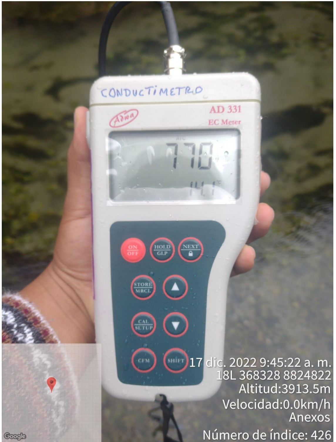
Medida in situ de la conductividad en Quebrada de Lloclla, Distrito de Yanacancha (Li-1)
