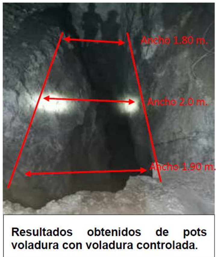
Figura 26. Resultados de post voladura controlada
