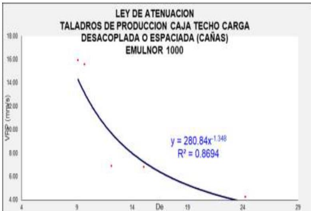
Figura 33. Ley de atenuación, taladros de caja techo con carga desacoplada o espaciada
