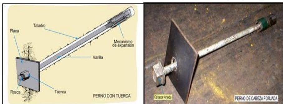
**Figura 11:** Tipos de pernos metálicos de anclaje mecánico. Pflucker (2019). Sostenimiento de labores subterráneas.
