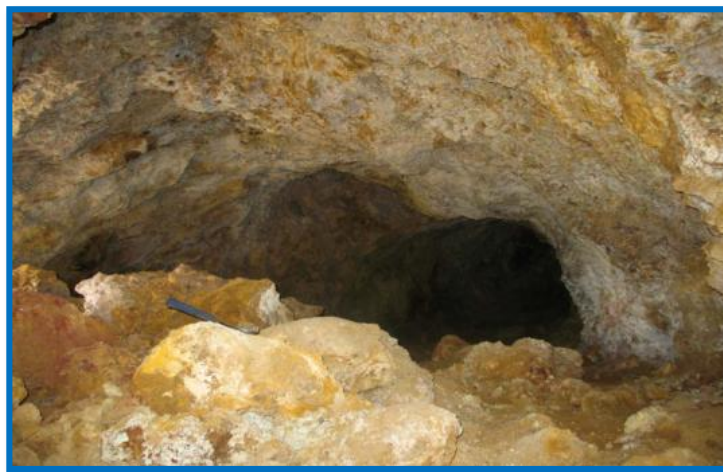
Foto N°4: Tajeos con Mineral Minado en el Piso y Mineral Masivo de Esfalerita en el Techo, se observa Falla con Óxidos de Fierro y Caolín.
