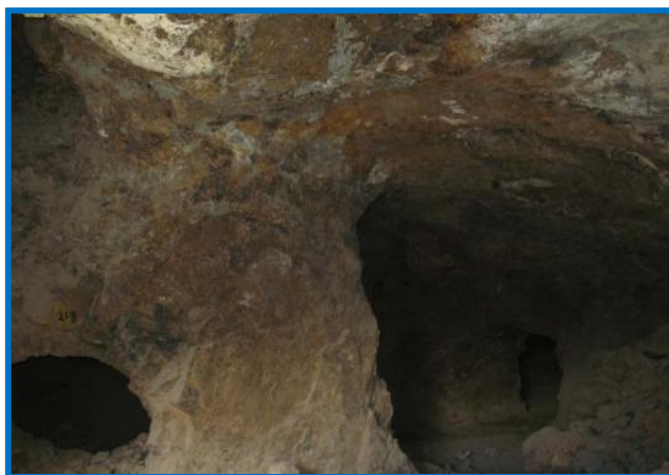
Foto N° 3: Labores subterráneas, se observa los Pilares con Mineral de Marmatita Masiva, Galena, Pirita, con Repliegues de los Mantos.
