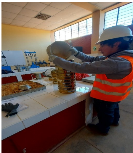
FOTO N°17: TAMIZADO DE LA MUETSRA - SANTA ROSA DE PITIC-LA QUINUA.
