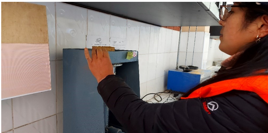
FOTO N°27: LUEGO EXTRAEMOS EL ESPECIMEN DEL MOLDE
