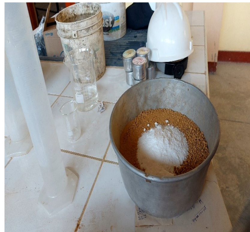
FOTO N° 44: AÑADIMOS AGUA A NUESTRA MUETSRA DE SUELO PARA ALCANZAR LA HUMEDAD OPTIMA
