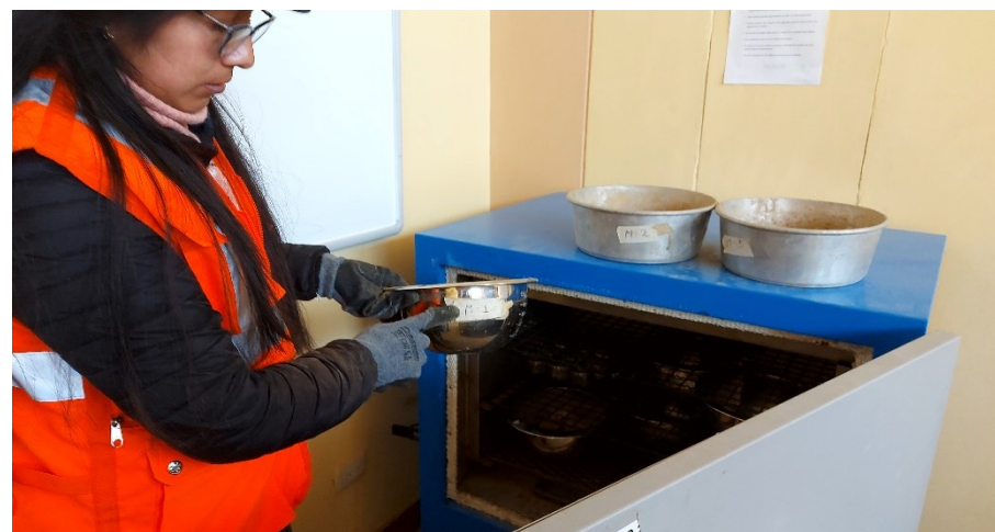
FOTO N° 30: LA OTRA PARTE DE LA MUESTRA SE SECA EN EL HORNO DONDE PERMANECE DURANTE UNAS HORAS, PARA LUEGO CALCULAR LA HUMEDAD DE LA MUESTRA DEL TERRENO.
