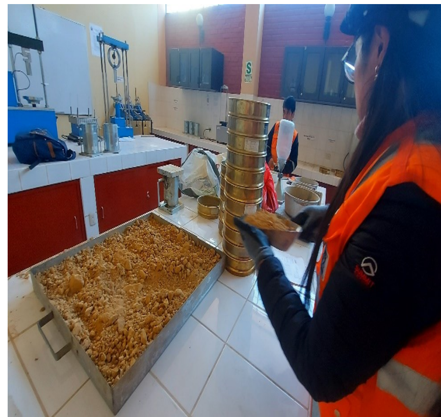
FOTO N° 20: SE PROCEDE CPN EL CUARTEADO CORRESPONDIENTE Y SE TMA LAS MUESTRA LA CANTIDAD DE 2300 GR-PARA FEALIZAR EL ENSAYO (PRIMERA MUESTRA)
