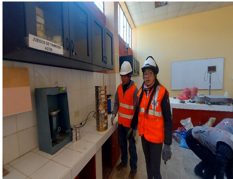
FOTO N°14: ENSAYO DE GRANULOMETRIA -SELECCIONANDO TAMICES.
