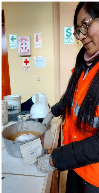
FOTO N°43: DESPUES DE DETERMINAR LAHUMEDAD OPTIMA Y DENSIDAD MAXIMA DE LA MUETSRA DE SUELO MEDIANTE EL ENSAYO PROCTOR MODIFICADO AÑADIMOS EL CLORURO DE SODIO Y CLORURO DE CALCIO
