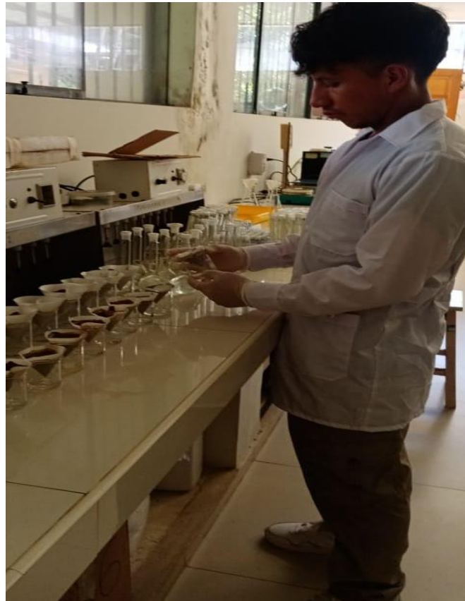
Foto 4. Determinación de bicarbonatos en agua.
