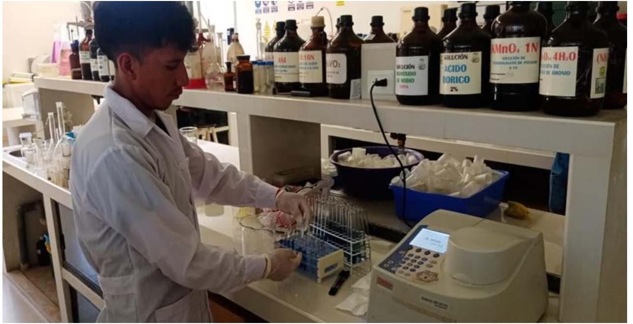
Foto 7. Determinación de la dureza del agua.
