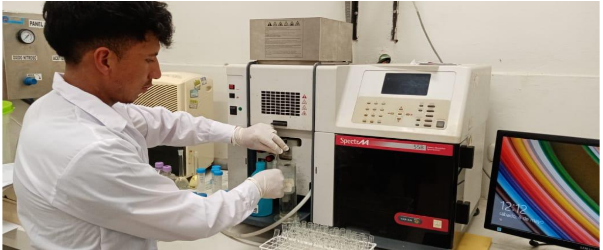
Foto 5. Cuantificación de Mg, Ca, Fe, Zn, Cu, y Mn en el espectrofotómetro de absorción atómica
