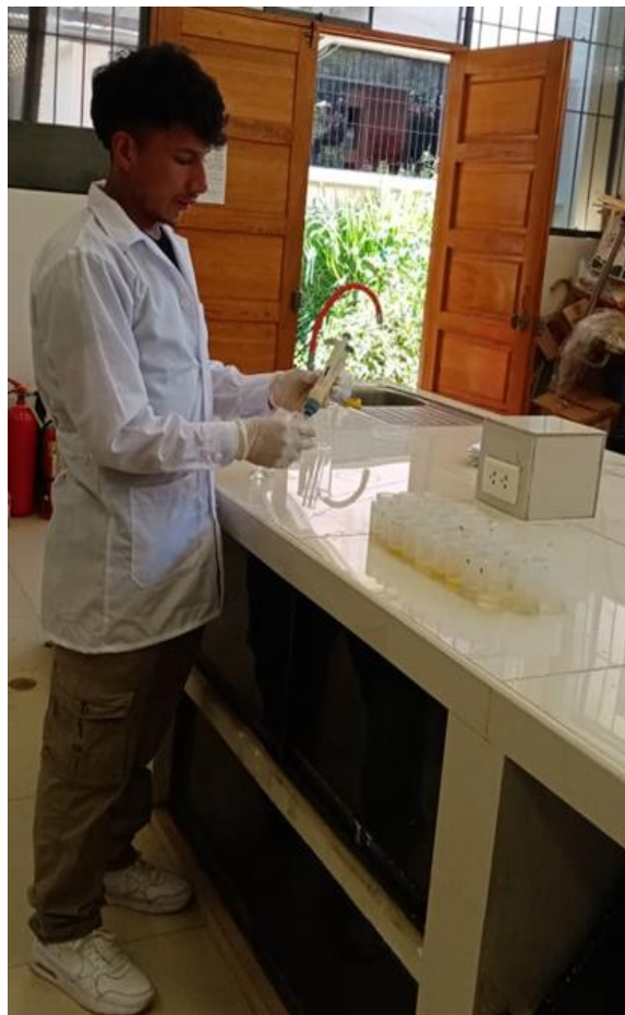
Foto 6. Determinación del PH y conductividad eléctrica
