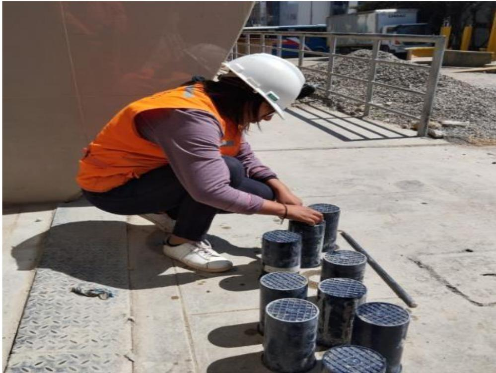
**Fotografía 01.** Proceso de preparación de los moldes para realizar las probetas.
