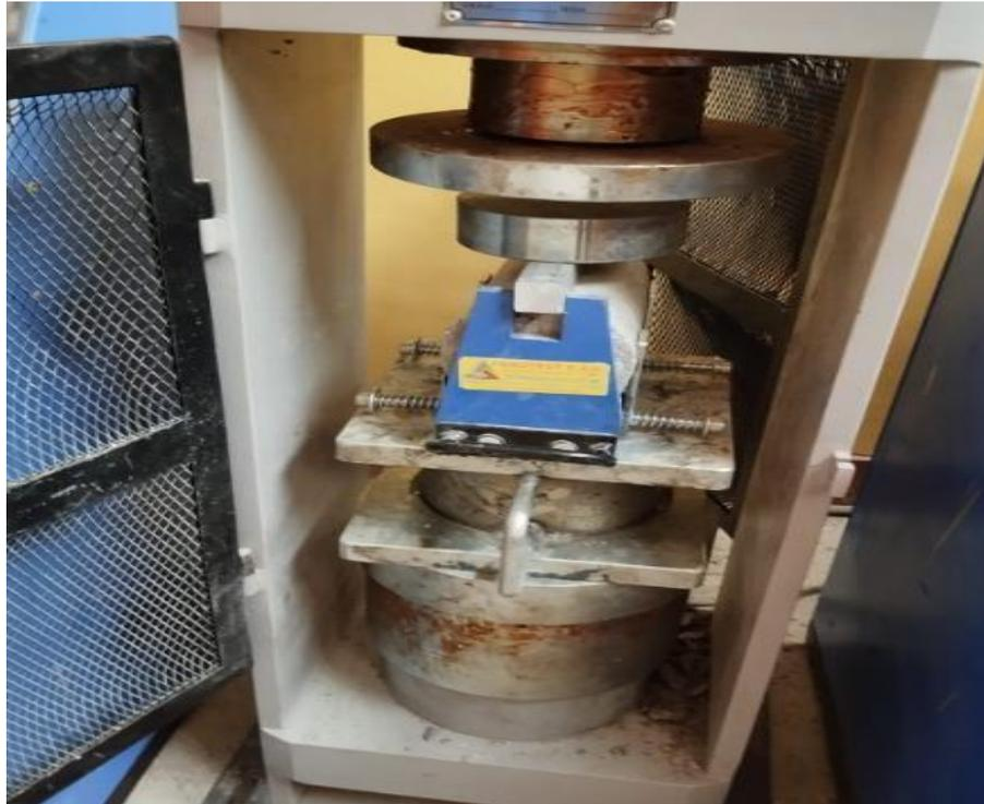
**Fotografía 28.** Proceso de ensayo para la resistencia a la tracción indirecta
