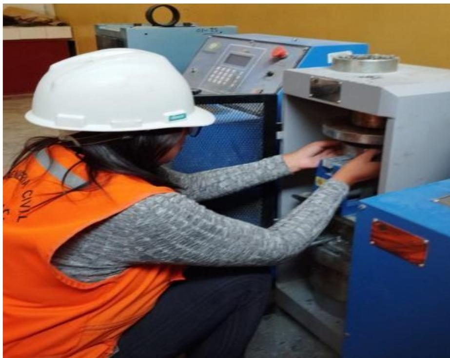
**Fotografía 26.** Proceso de ensayo para la resistencia a la tracción indirecta
