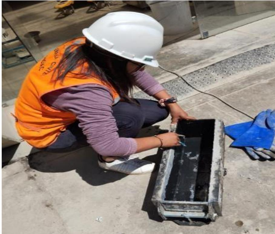
**Fotografía 03.** Proceso de preparación de los moldes para realizar las vigas.
