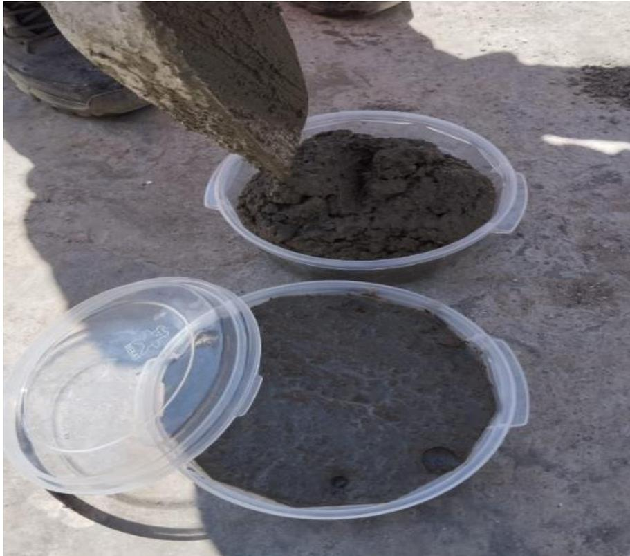
**Fotografía 08.** Extrayendo muestras para verificar los tiempos de fraguado del concreto
