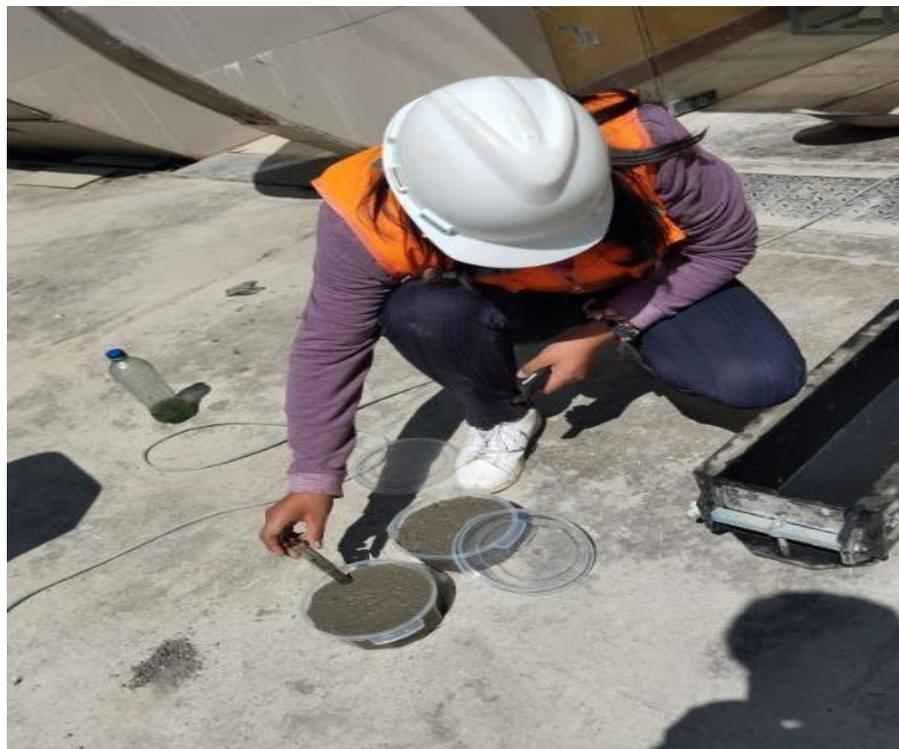
**Fotografía 09.** Verificando el tiempo de fraguado del concreto
