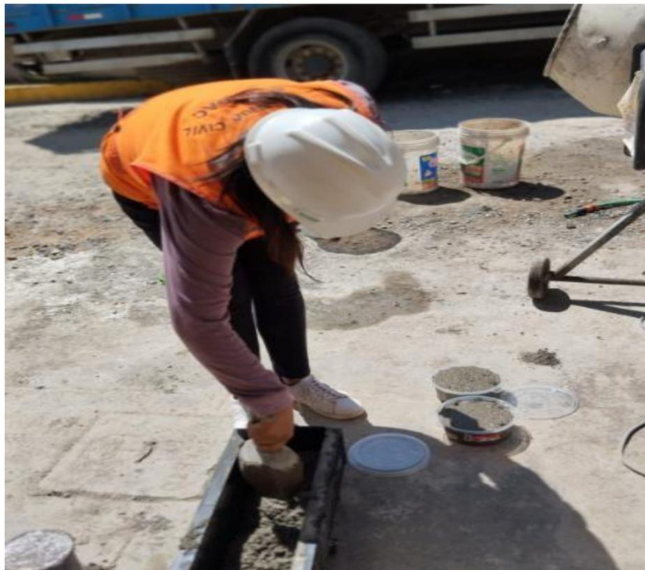
**Fotografía 11.** Proceso de llenado de la mezcla de concreto para realizar las vigas
