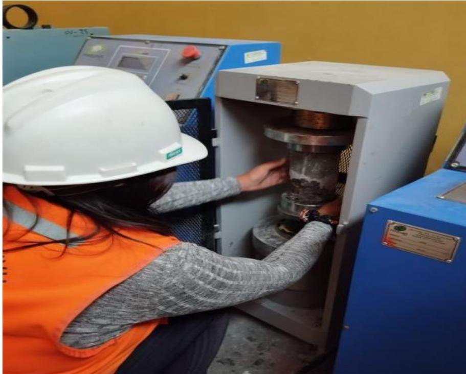
**Fotografía 24.** Proceso de ensayado para la resistencia a la compresión.
