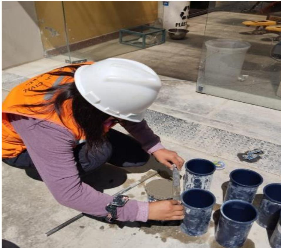
**Fotografía 17.** Proceso del enrasado para dar el acabado final de las probetas
