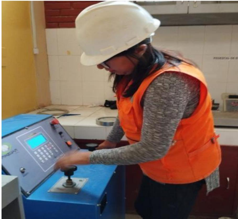
**Fotografía 27.** Proceso de control de velocidad para la resistencia a la tracción indirecta
