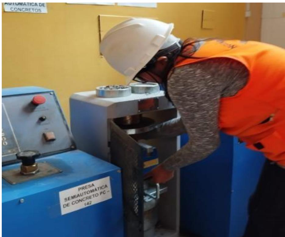
**Fotografía 29.** Proceso de ensayo para la resistencia a la tracción indirecta
