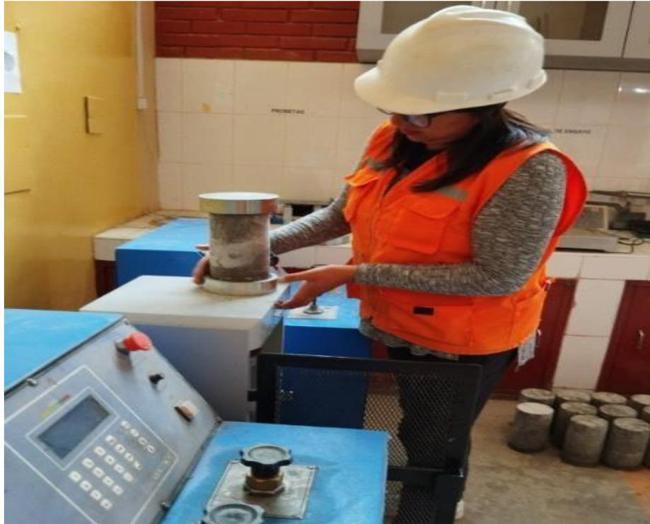
**Fotografía 22.** Proceso de ensayo para la resistencia a la compresión.
