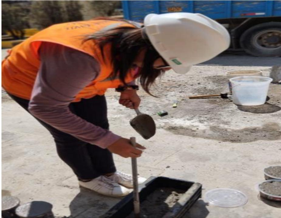
**Fotografía 12.** Proceso del chuceado para homogenizar el concreto en las vigas.
