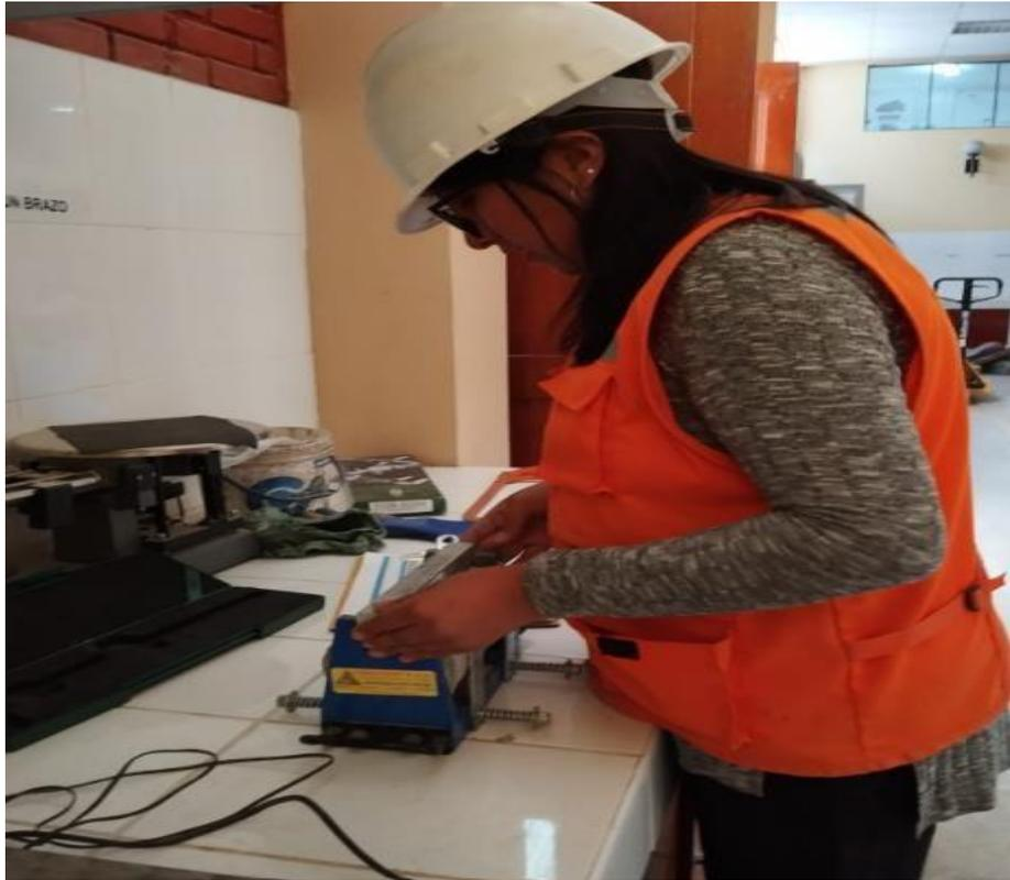
**Fotografía 25.** Proceso de ensayo para la resistencia a la tracción indirecta
