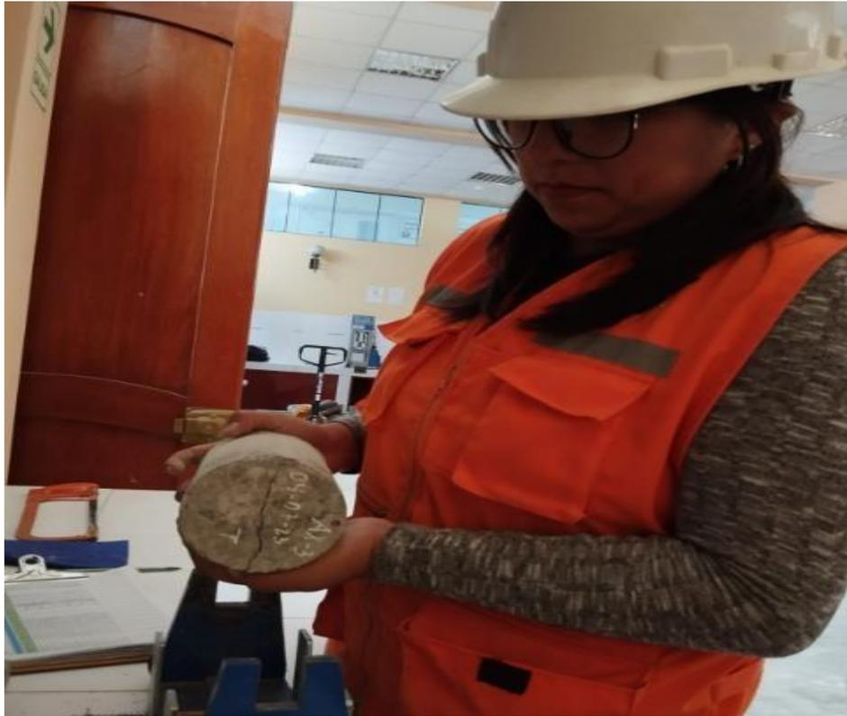
**Fotografía 30.** Verificando el tipo de corte de la resistencia a la tracción indirecta
