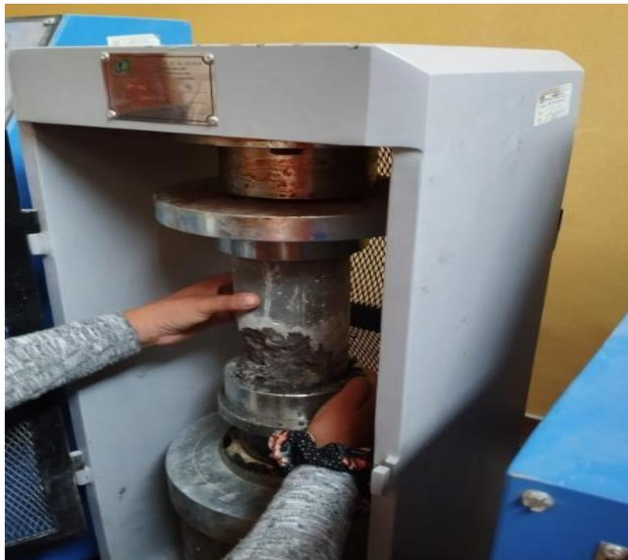
**Fotografía 23.** Proceso de ensayado para la resistencia a la compresión.
