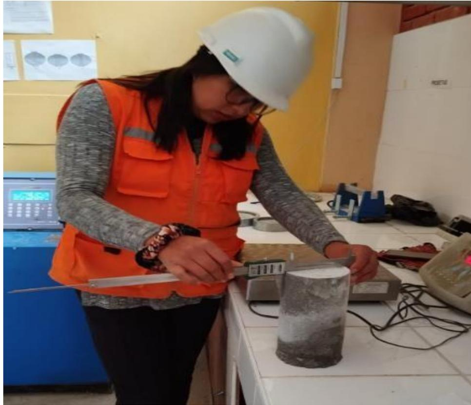
**Fotografía 20.** Proceso de tomas de medidas de las probetas
