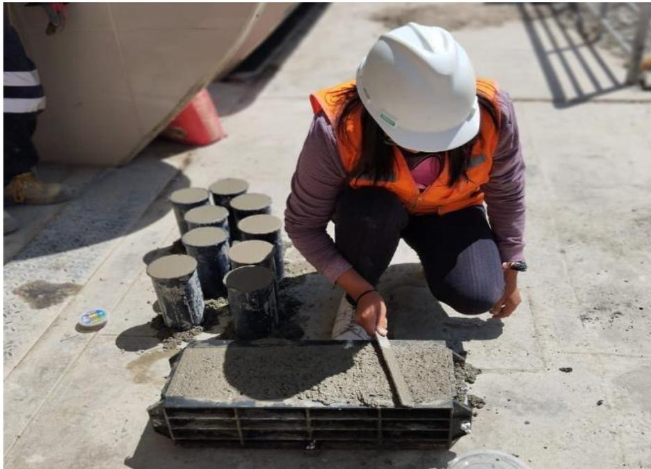
**Fotografía 14.** Proceso del enrasado para dar el acabado final de las vigas
