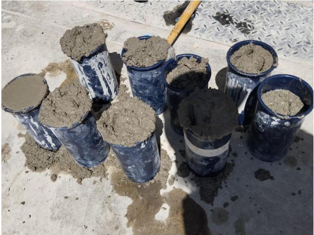
**Fotografía 15.** Proceso de la elaboración de las probetas de concreto de 4"x8"
