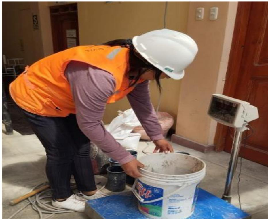
**Fotografía 04.** Proceso de toma de pesos de los agregados para el diseño de mezcla.
