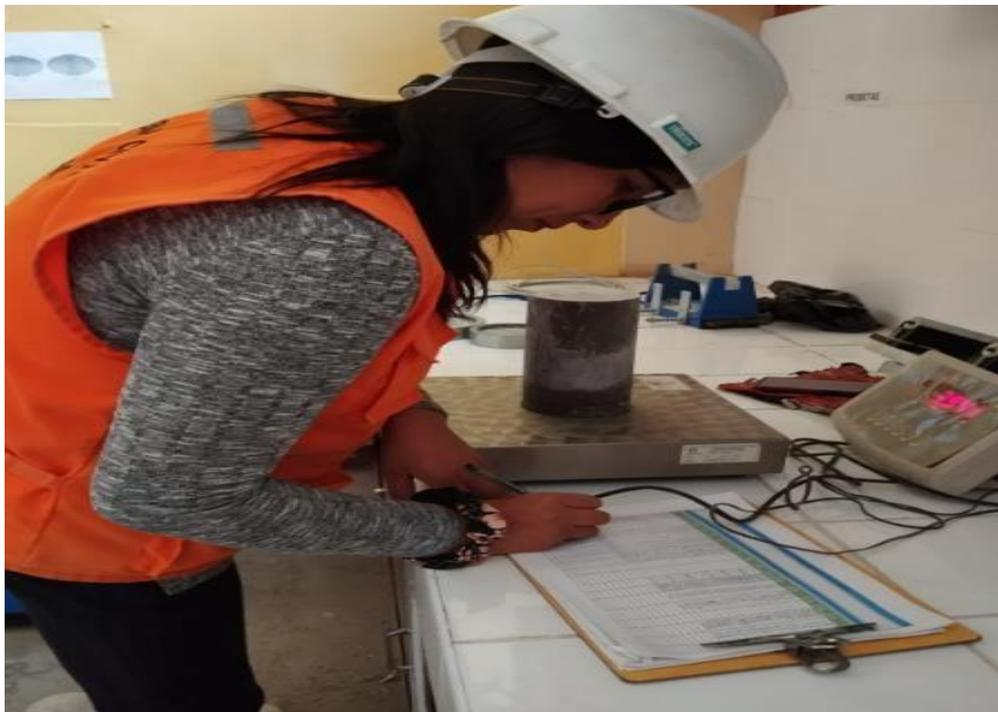
**Fotografía 19.** Proceso de tomas de pesos de las probetas
