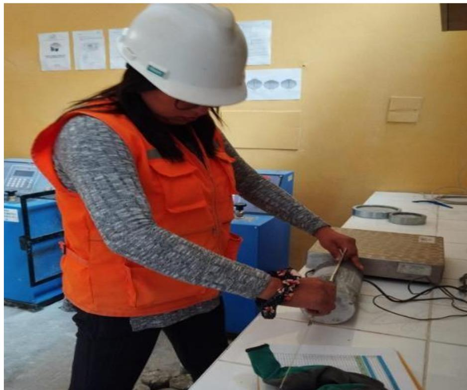
**Fotografía 21.** Proceso de tomas de medidas de las probetas
