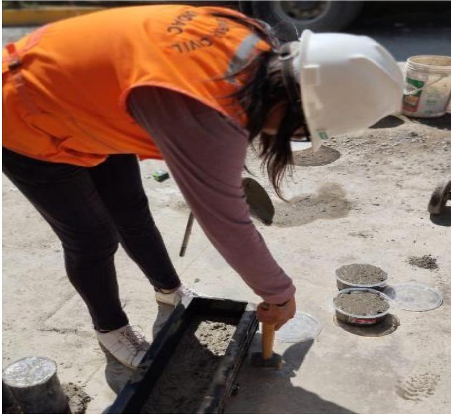
**Fotografía 13.** Golpeo en los laterales de las probetas con comba de goma
