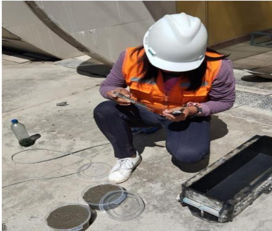
**Fotografía 10.** Verificando el tiempo de fraguado del concreto
