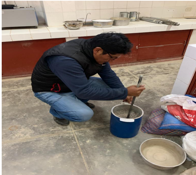
Fotografía 1.- Ensayo de peso unitario compactado del agregado
