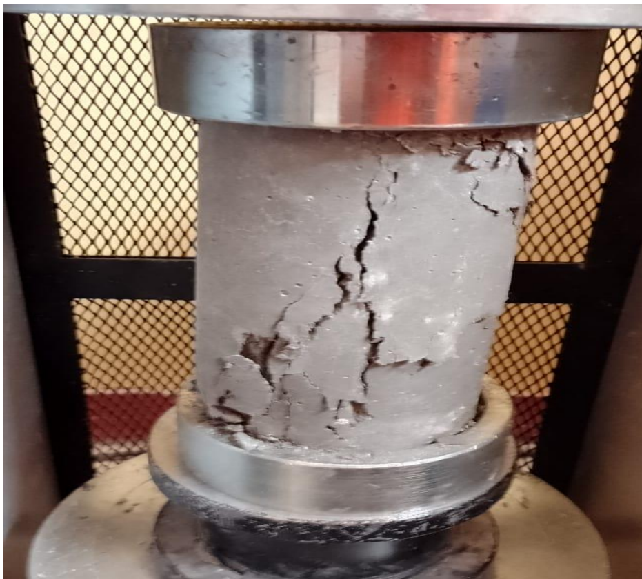
Fotografía 6.- Ruptura en la prensa del ensayo a compresión
