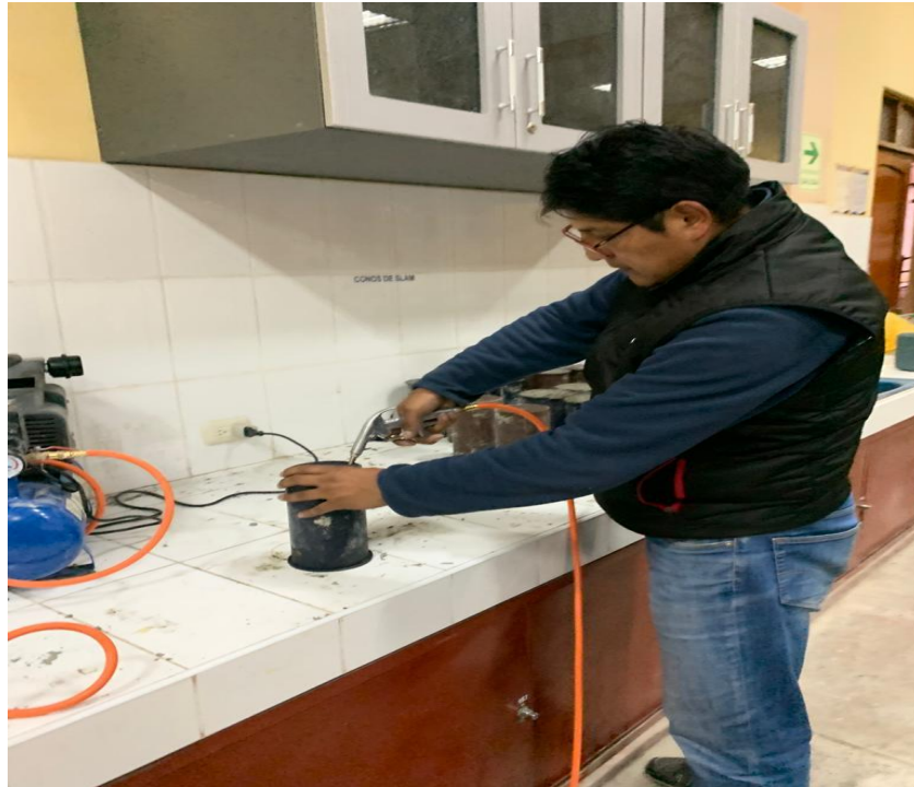
Fotografía 17.- Desmoldamiento de probetas cilíndricas
