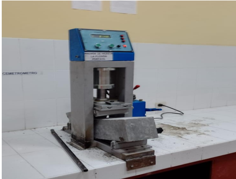
Fotografía 15.- Rotura de viga mediante el ensayo a flexión en la prensa
