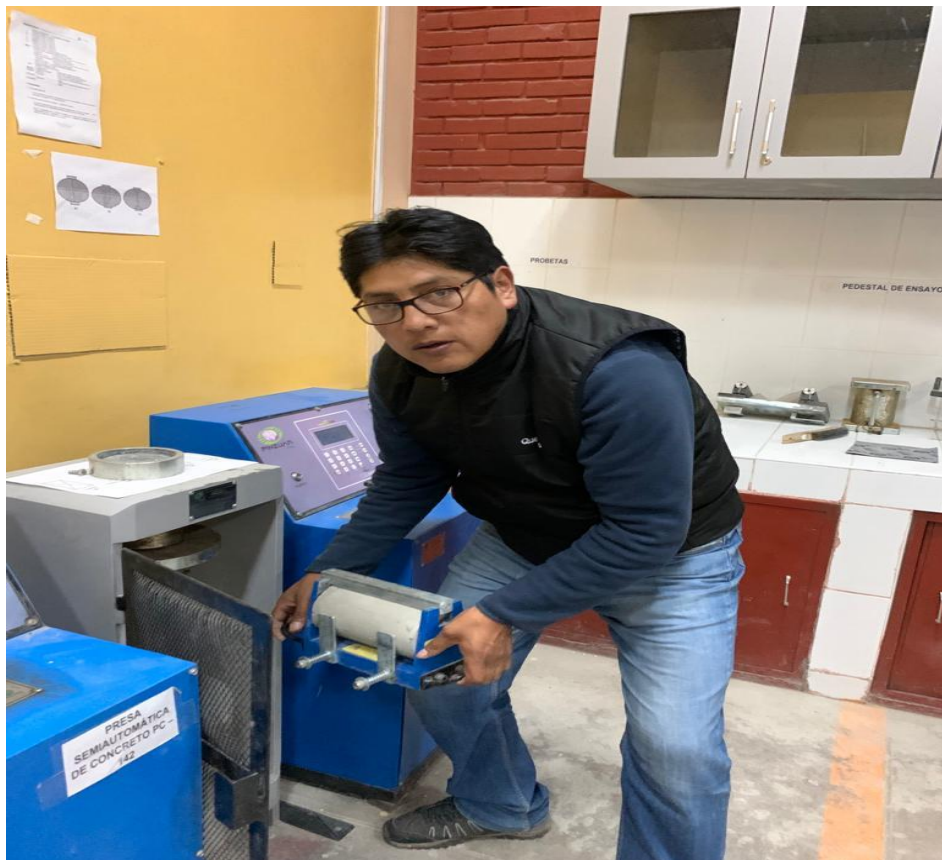
Fotografía 10.- Colocación de la probeta para el ensayo de tracción indirecta
