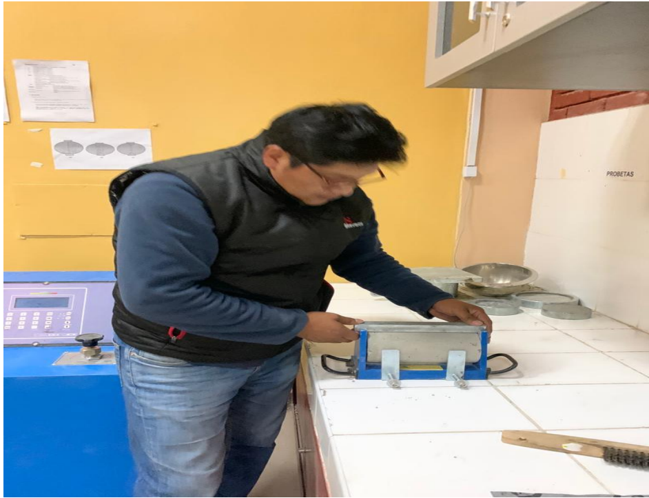
Fotografía 9.- Muestra lista para el ensayo a tracción indirecta
