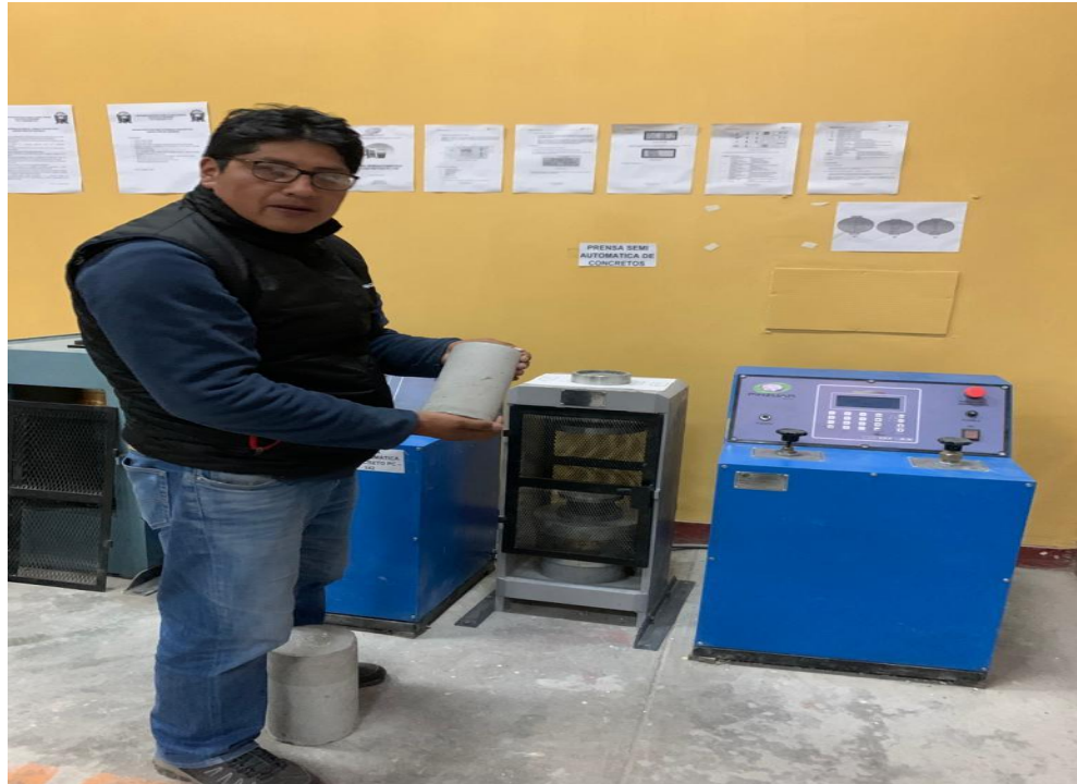
Fotografía 5.- Colocación de probeta en la prensa para el ensayo a compresión
