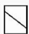
Tipo 4 Fractura diagonal sin fisuras a través de los extremos; golpe suavemente con un martillo para distinguirla del Tipo 1
