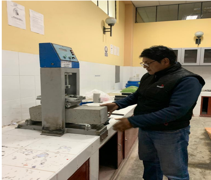
Fotografía 13.- Colocando la viga para el ensayo a flexión
