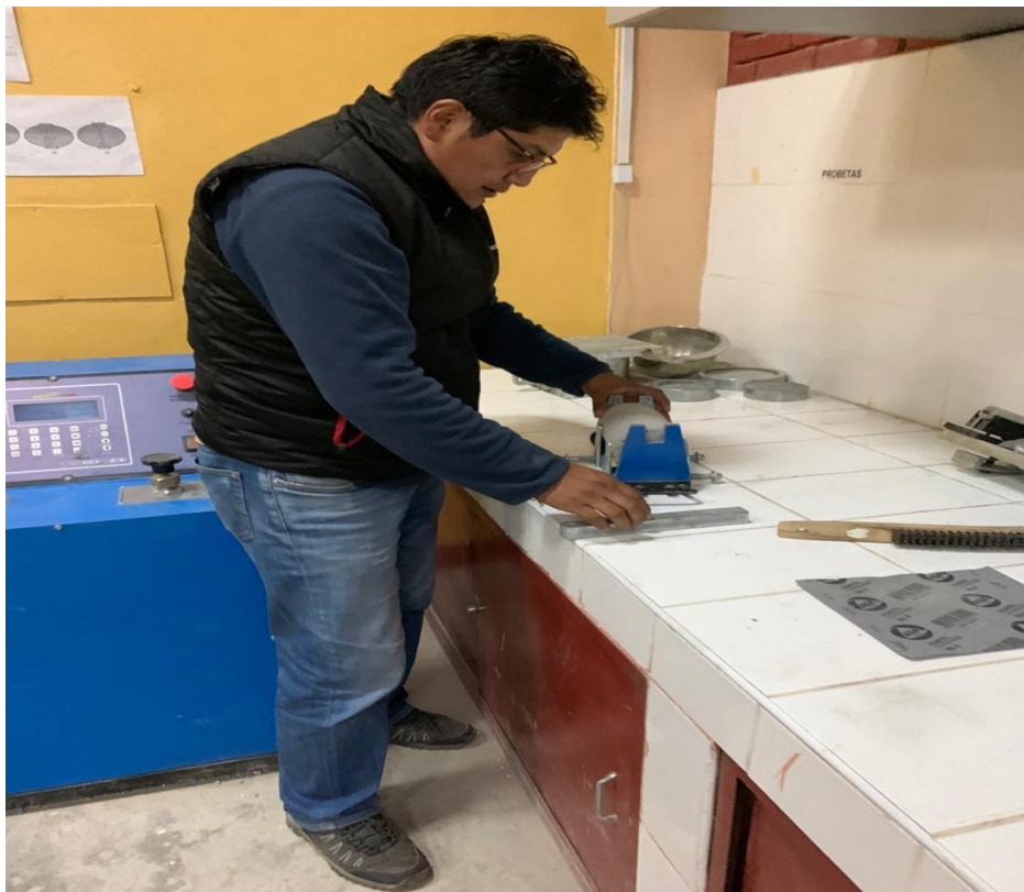
Fotografía 8.- Preparación de muestra para el ensayo a tracción indirecta
