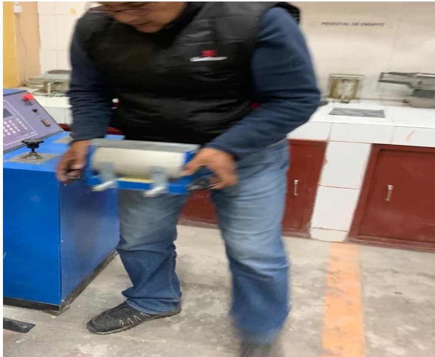
Fotografía 11.- Finalización del ensayo a tracción indirecta en la prensa semiautomática
