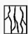
Tipo 3 Fisuras verticales enclavadas a través de ambos extremos, conos mal formados
