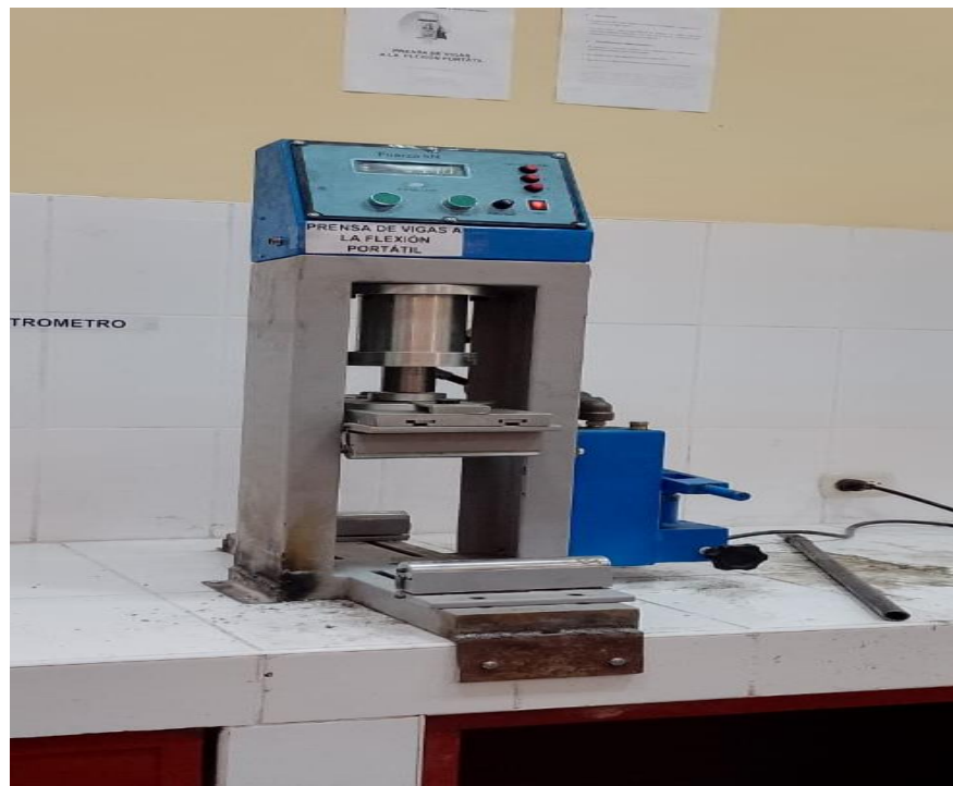
Fotografía 12.- Preparación de la prensa para el ensayo a flexión
