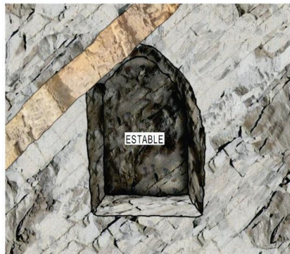
Acomodo de la excavación a los rasgos estructurales
