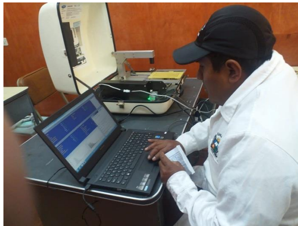
Fotos: Procedimiento de análisis de fibra con el equipo OFDA 2000. Laboratorio “UNDAC”
