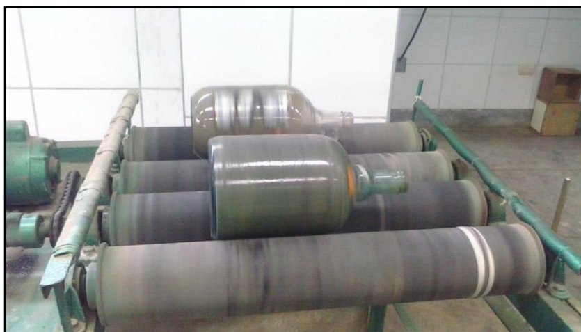
Figura 2 Lixiviación por cianuración en botellas
