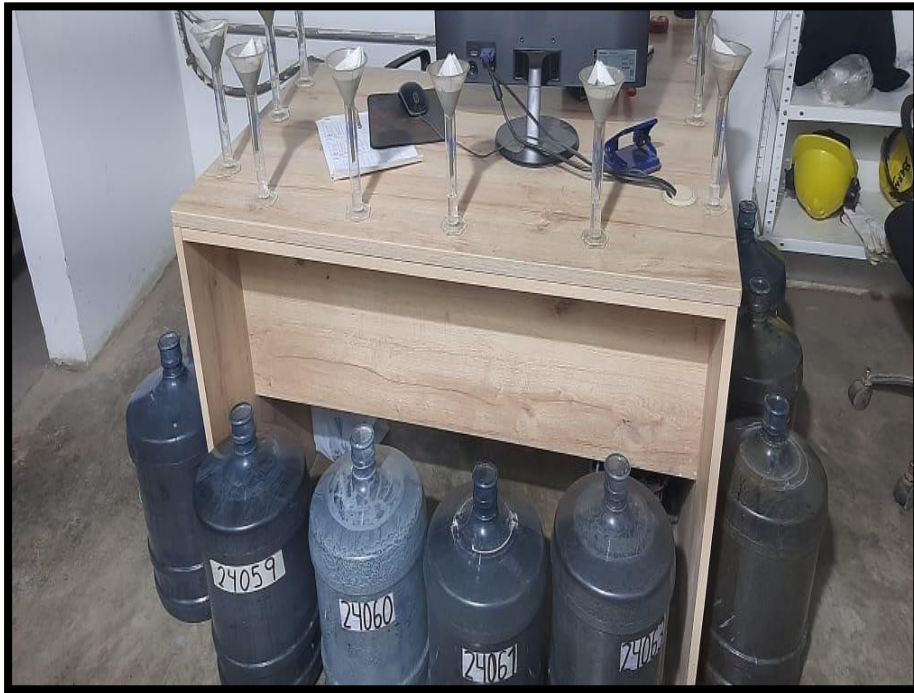
Vista de filtración de las muestras – Laboratorio Metalúrgico.
