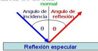
Figura 5 Reflexión y refracción de la luz
