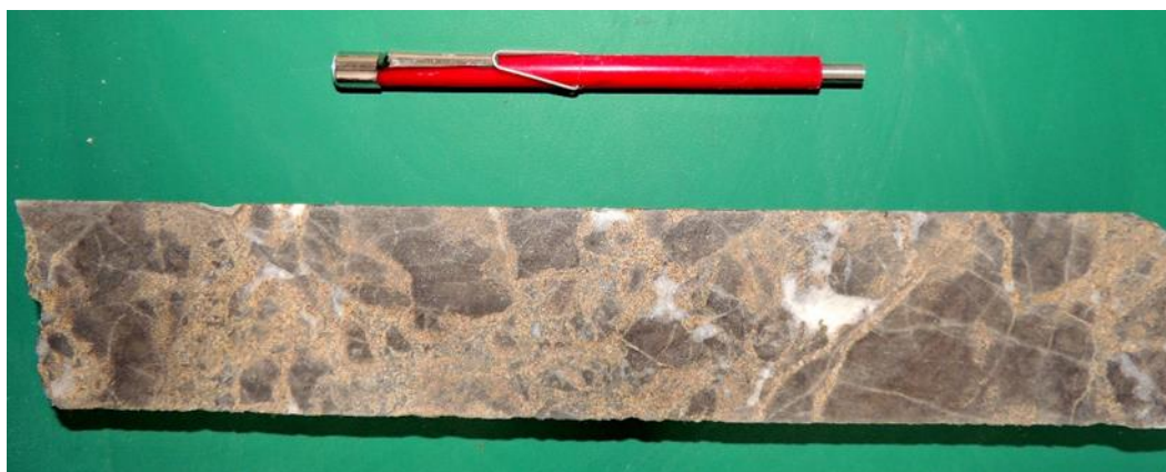
Figura 48. Brecha evaporítica, con clastos de dolomía beige oscuro wackestone, con calcita y esfalerita diseminada. SH-54 (415.60 m).
