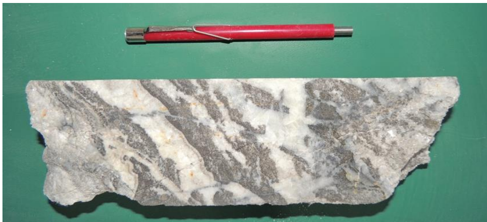
Figura 47. Brecha evaporítica con clastos de dolomía wackestone, y matriz de doloesparita y pirita en parches del Manto Intermedio SH-70 (278.30 m).
