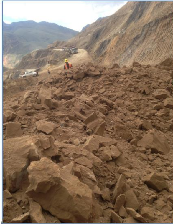
Figura 45 Fragmentación gruesa en zona de taco en el disparo 17 Nv427 Tajo Seductora, diámetro de pelota: 17.2cm
