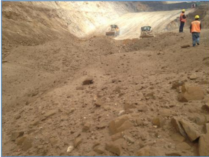
Figura 47 Fragmentación Fina en zona de taco en el disparo 17 Nv 427 Tajo Seductora, diámetro de pelota: 17.2cm
