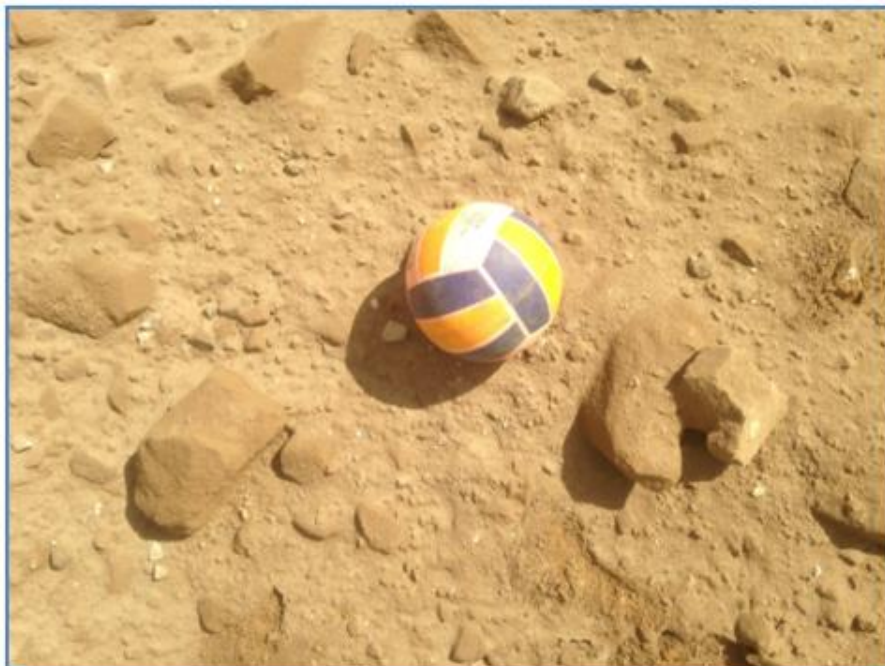
Figura 47 Fragmentación Fina en zona de taco en el disparo 17 Nv 427 Tajo Seductora, diámetro de pelota: 17.2cm
