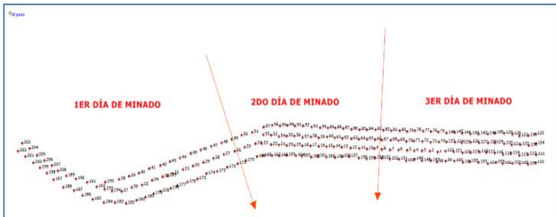
Figura 32 Diseño de malla de voladura en el proyecto 159 igual a 5.5m x 5.5m y 4.2mX4.2m
