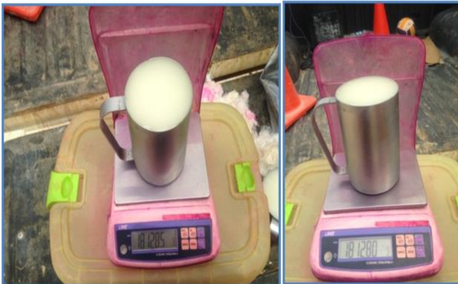
Figura 21 Toma de densidades al lote de emulsión
