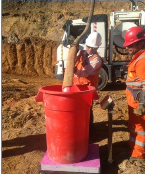
Figura 49 Calibración de camiones en campo
