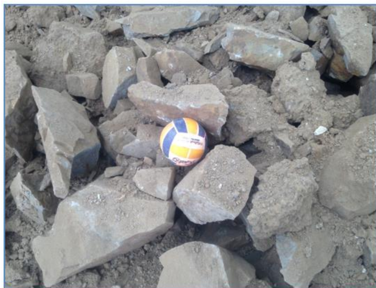
Figura 45 Fragmentación gruesa en zona de taco en el disparo 17 Nv427 Tajo Seductora, diámetro de pelota: 17.2cm
