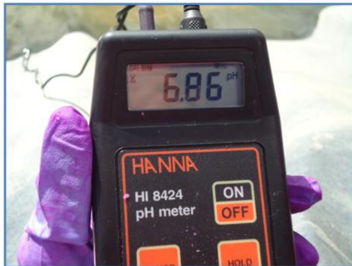
Figura 20 Medición de PH con la que se prepara la solución gasificante
