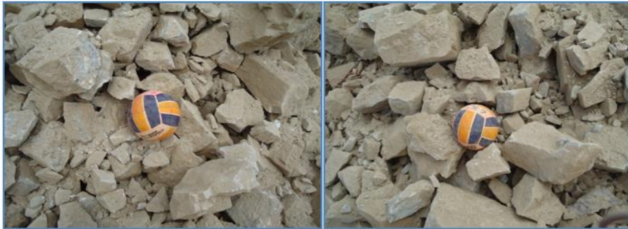
Figura 31 Fragmentación a nivel de taco en roca dura en el Proy 157, diámetro de pelota =17.1cm
