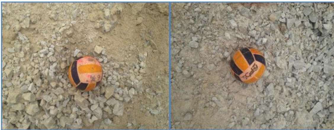
Figura 34 Fragmentación durante el minado en el Proy 159 Tajo Clarita. La pelota tiene un diámetro de 17.2 cm
