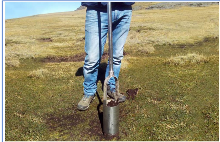
Figura 5. Barreno para hacer hoyo en el bofedal y medir la profundidad de la turba
