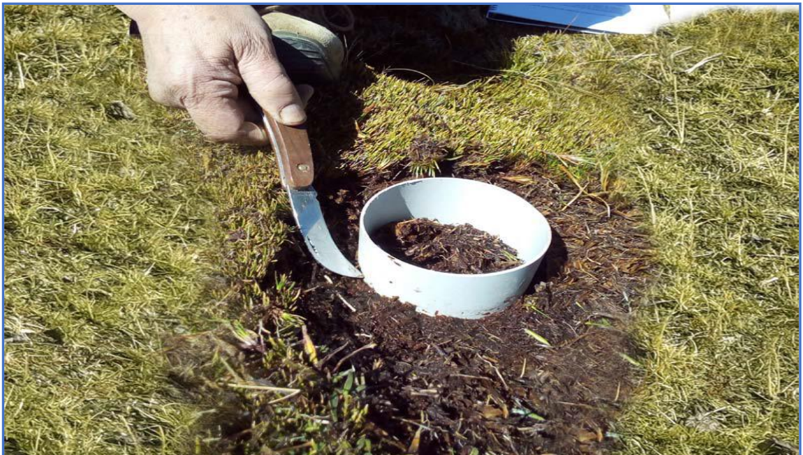
Figura 6. Forma de extracción de muestra para calcular la densidad aparente
