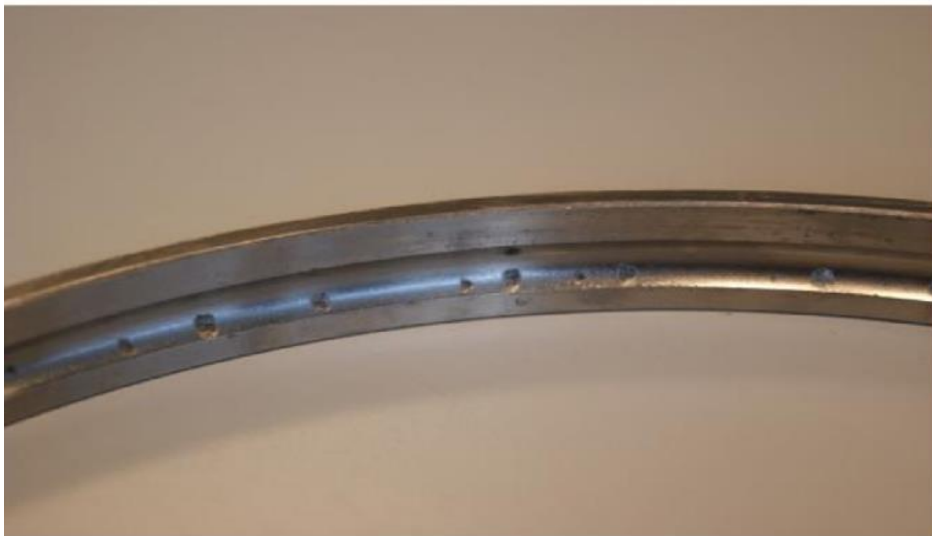
Figura 22: Voltaje excesivo en rodamiento, provocando pitting localizado
