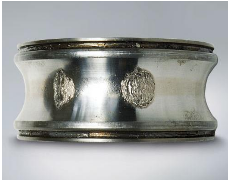
Figura 20: Elementos rodantes impresos en los caminos de rodadura provocado por un montaje inadecuado (Problema: sobrecarga)
