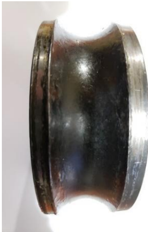
Figura 17: Indentaciones generadas por ingreso de agua en el rodamiento
