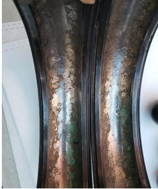
Figura 15: Falla en rodamiento por exceso de grasa, cambio en la coloración de los caminos de rodadura (Problema: lubricación).
