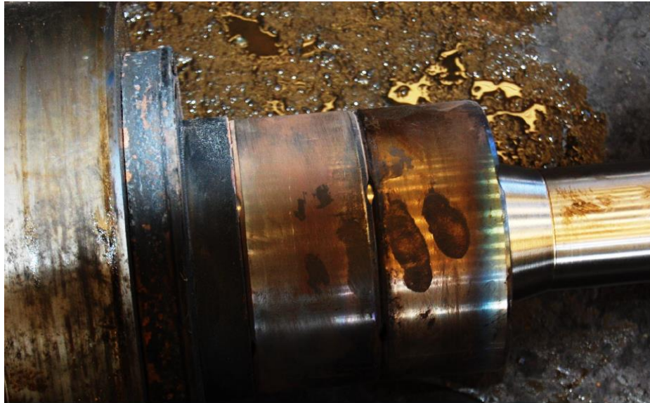
Figura 22: Voltaje excesivo en rodamiento, provocando pitting localizado
