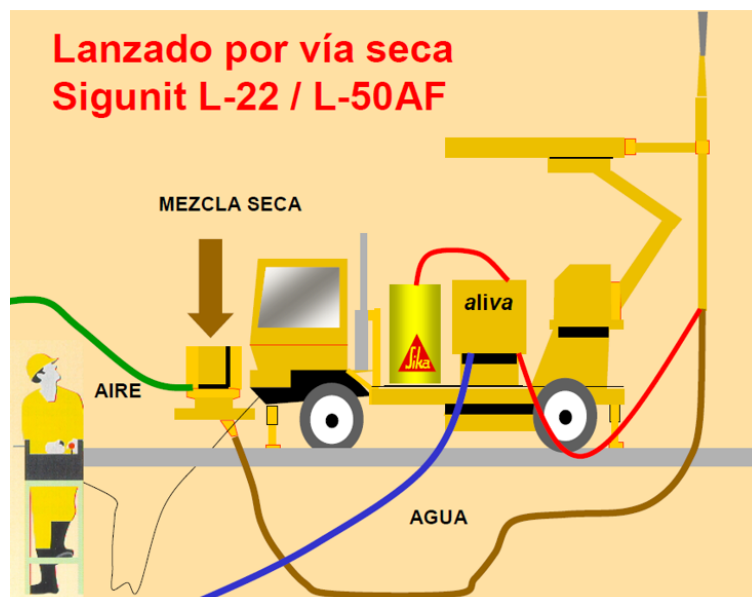
Figura 17: Shotcrete vía seca.
