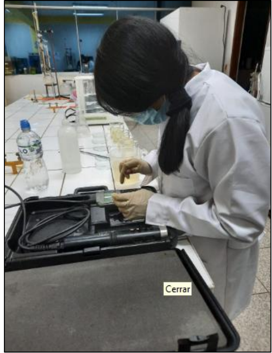
Imagen N° 14. Calibración de Conductividad – Concentración en el laboratorio.
