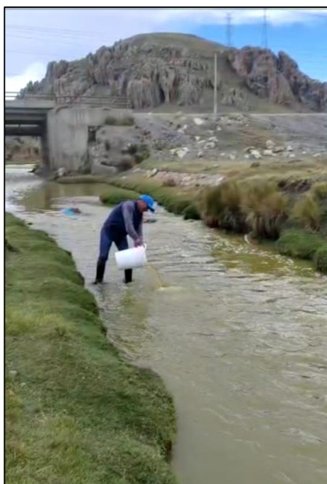
10.a. Inyección de Trazador salino.
