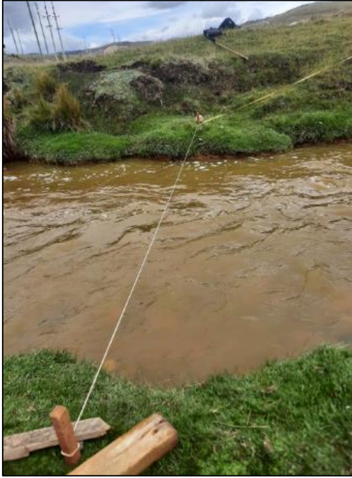
Imagen N° 12. Medición de área transversal del río.
