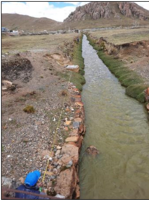
Imagen N° 10. Medición de tramos y ubicación de punto de inyección de trazador salino.
