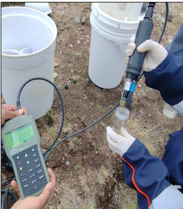
Imagen N° 11. Calibración de Multiparámetros.
