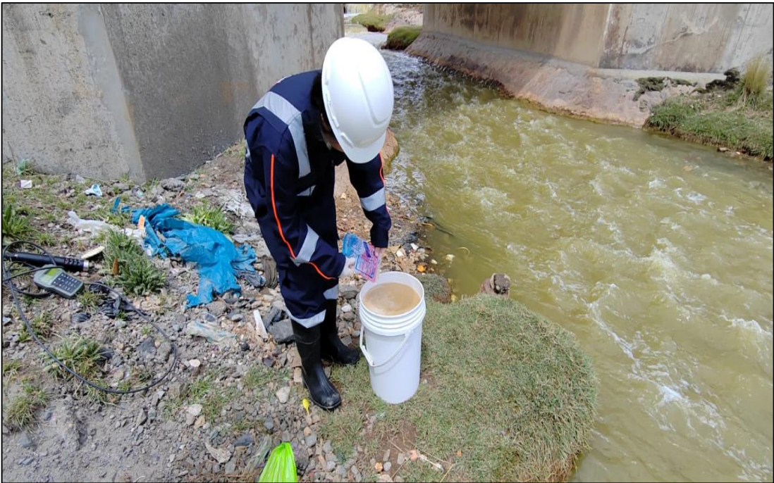
Imagen N° 13. Preparación de Solución con Sal y agua del río Ragra.
