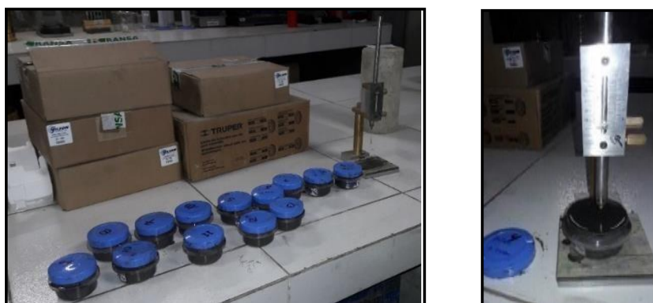
Ilustración 27. Muestras para realizar el secado con vicat
