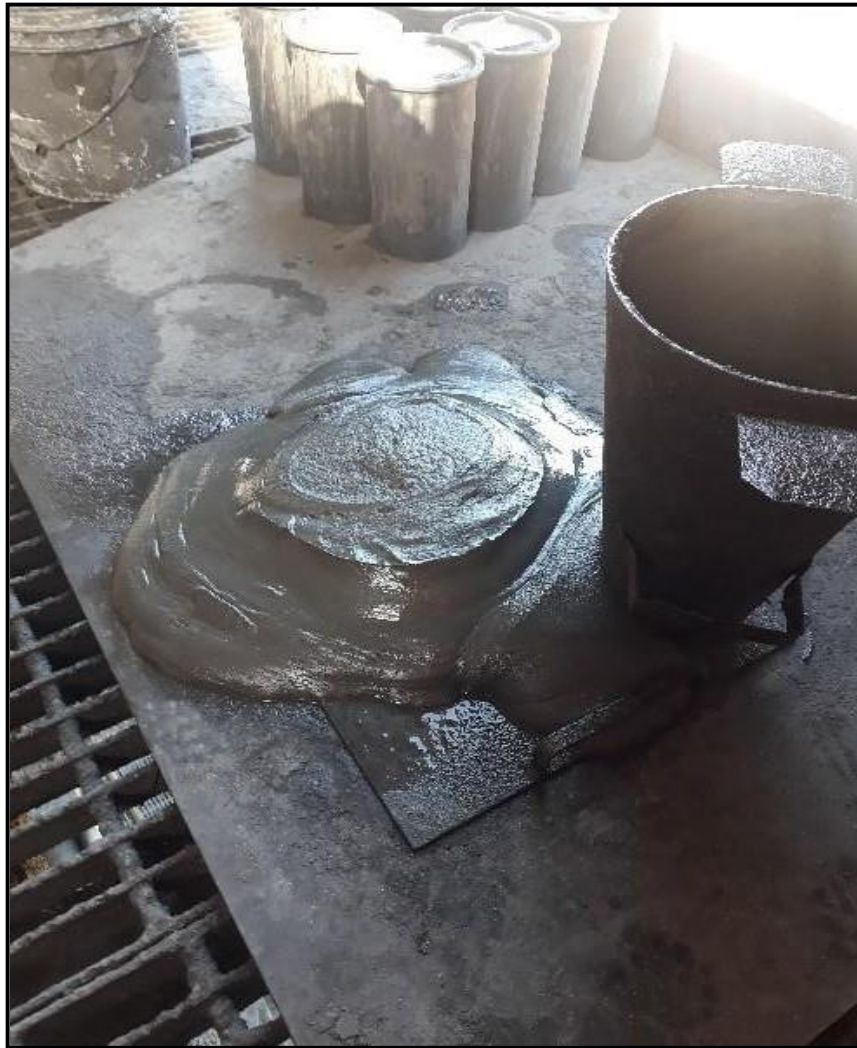
Ilustración 20. Prueba de slump de la pasta.
