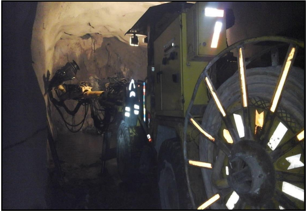
Ilustración 10. Equipo perforador frontonero en perforación.
