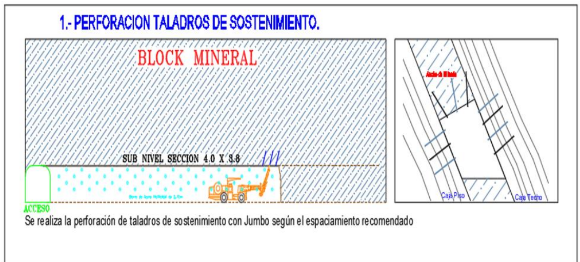
Perforación de taladros de sostenimiento
