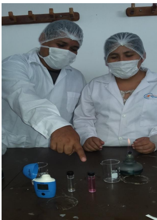
Figura 17: Test de Cloro Libre, Hanna, modelo: HI 701 para determinación de niveles de cloro libre residual en aguas.
