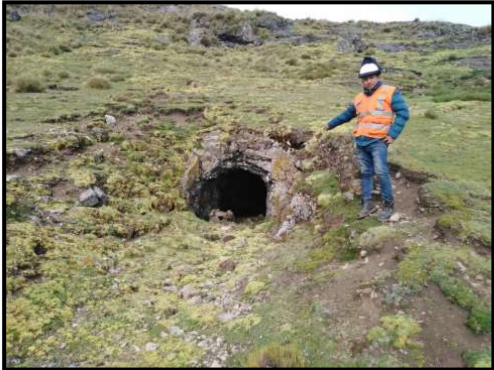
Fotografía N°10: Se observa una bocamina que representa un impacto ambiental en el medio físico
