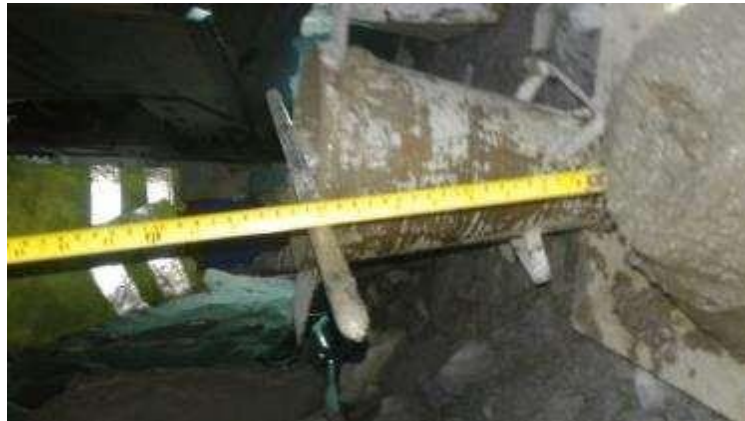
Medición De Slump En Mina
