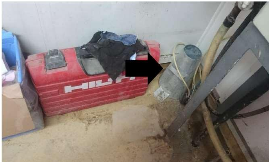
01 cono de abrams para medir el slump del concreto (nuevo)
