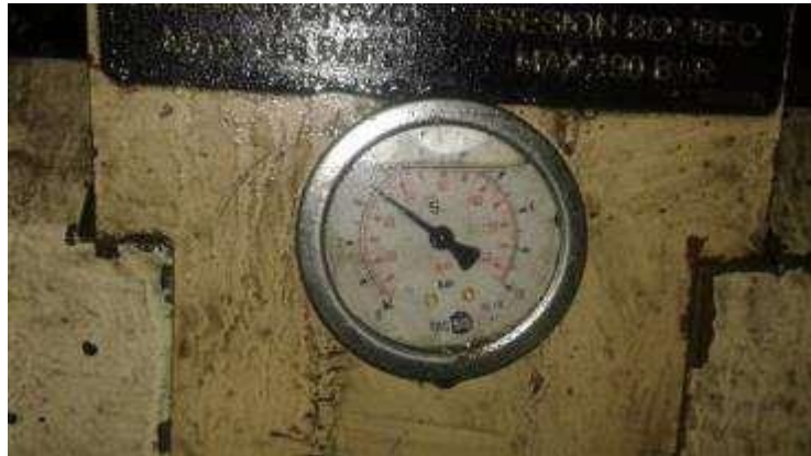
Manómetro Ubicado En El Robot Lanzador
