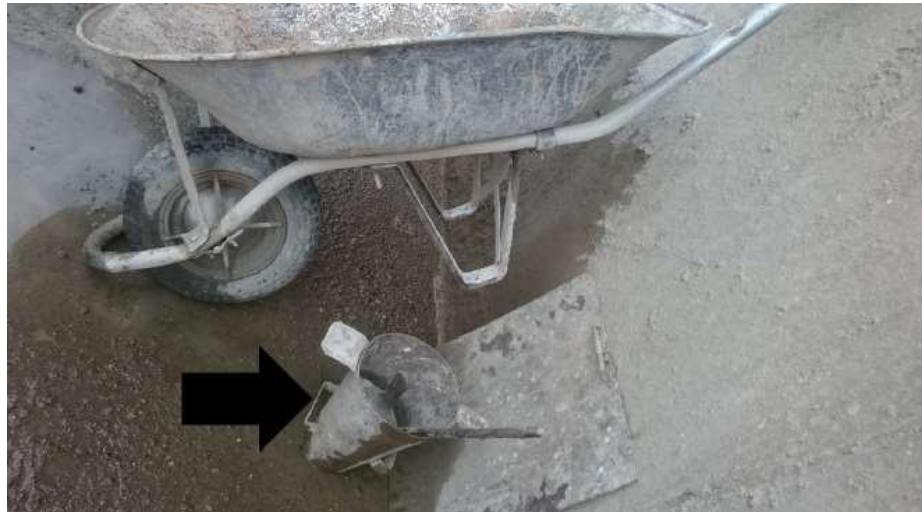
01 equipo para medición de slump: plancha, cono, varilla y cucharón (en mal estado)
