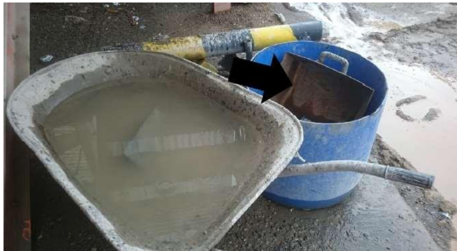
1 panel para muestreo de concreto shotcrete en interior mina (buen estado).
