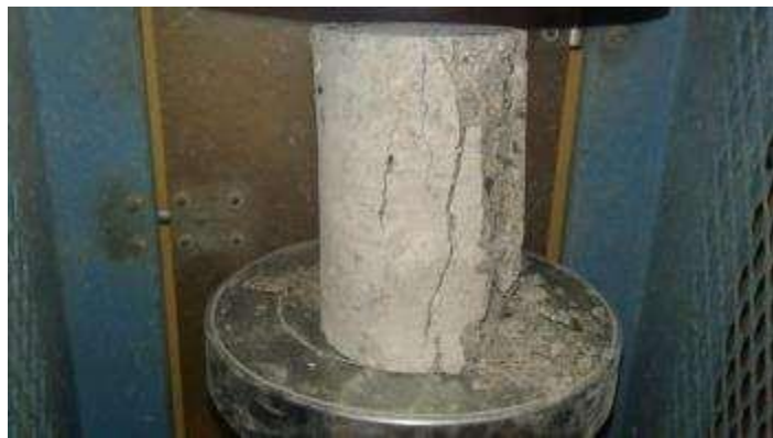
Ensayo De Resistencia Del Concreto
