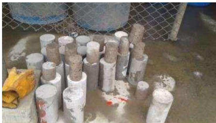
Ensayo De Resistencia Del Concreto
