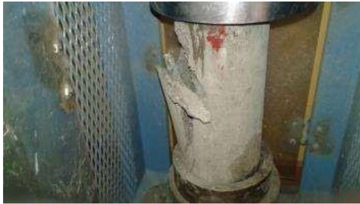
Ensayo De Resistencia Del Concreto
