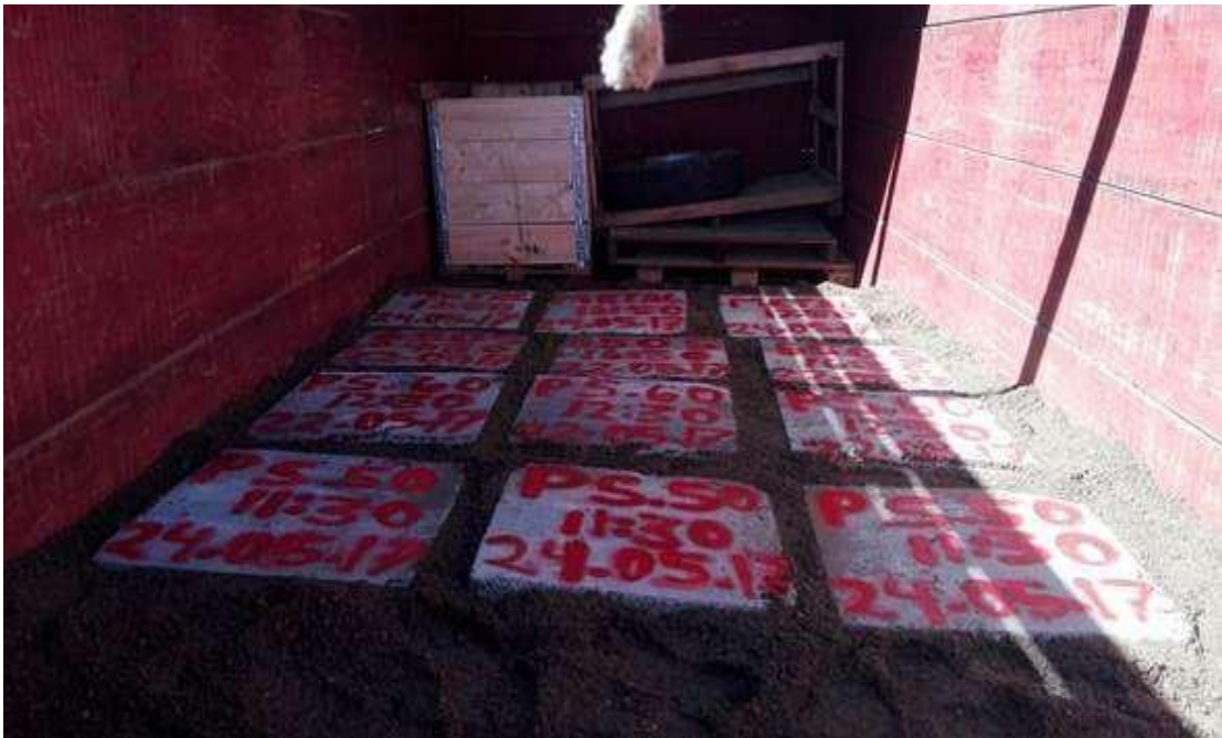
TRASLADO DE PANELES ROBOCON (POLYSTARK PS50, POLYSTARK PS60 Y FIBERMESH 600S).
