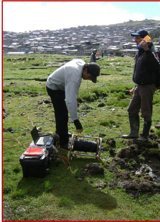
Se observa la ubicación de equipo de Refracción Sísmica y tendido de los cables Multicanal y geófonos.
