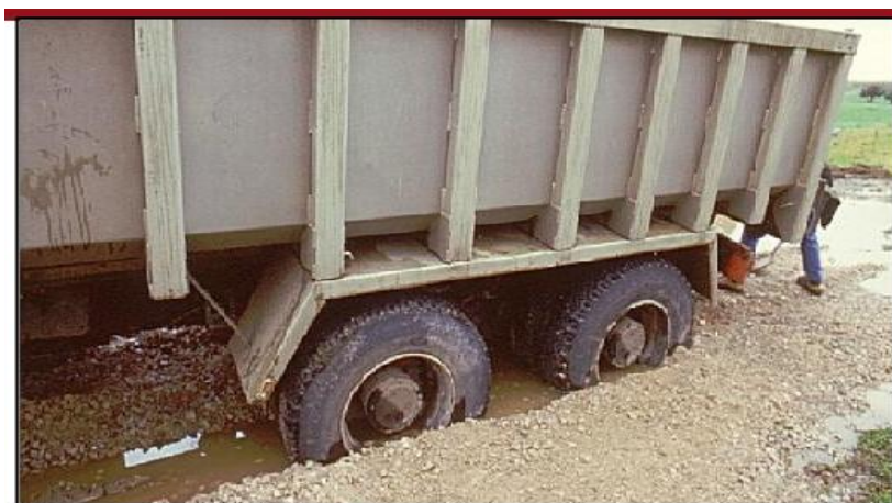
Figura 09. Problemas presentados en la superficie debido a la presencia de subrasantes blandas
