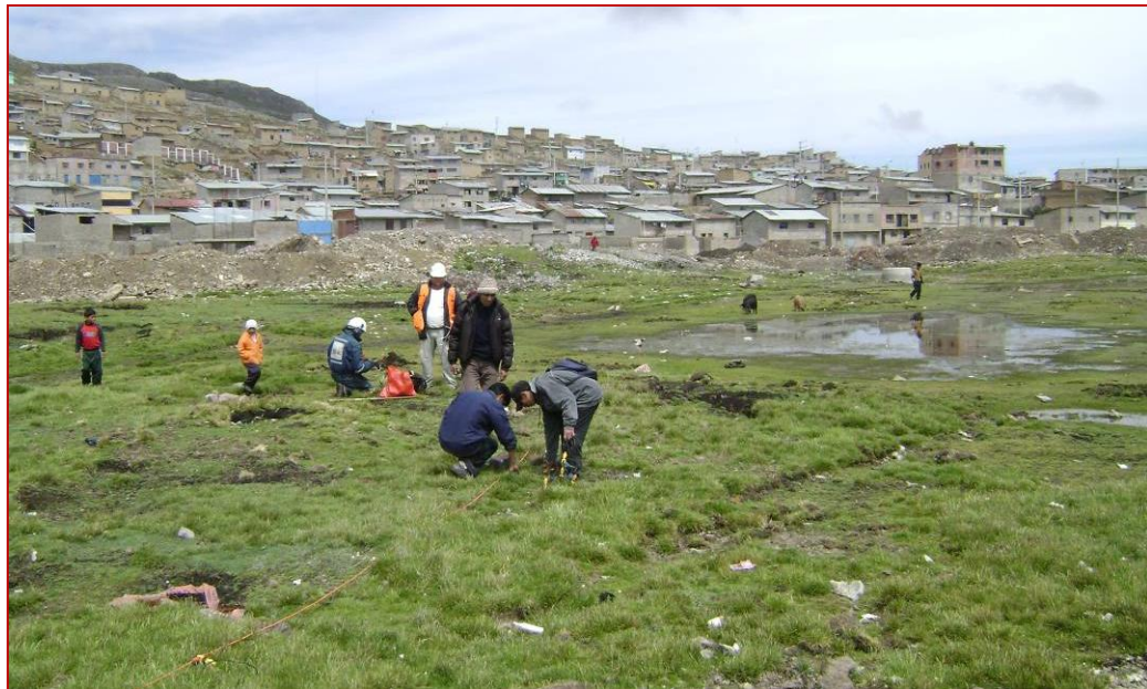
Se observa la ubicación de equipo de Refracción Sísmica y tendido de los cables Multicanal y geófonos.
