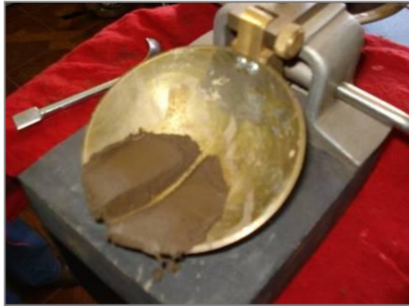
Ensayo determinación del límite líquido empleando la Copa Casagrande
